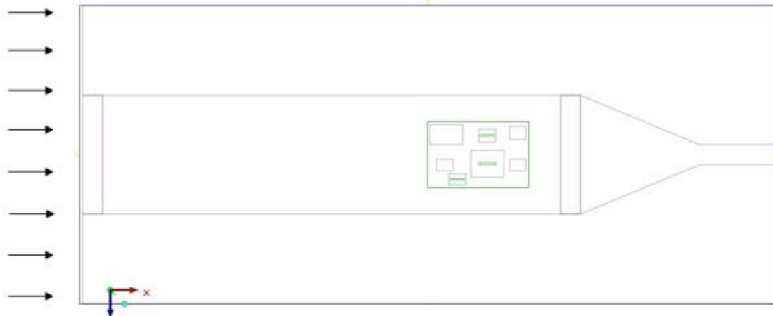
Figura 17 - Vista superior da réplica inserida no túnel de vento
