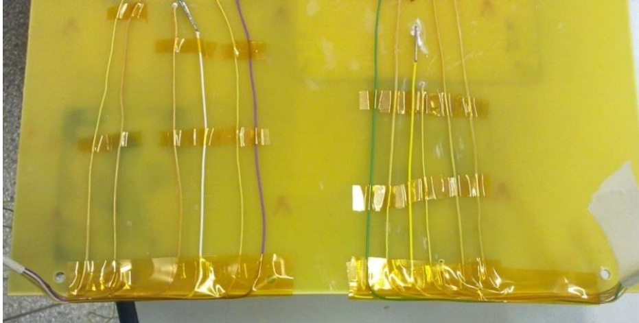
Figura 11 - Ordenação ao longo do escoamento dos fios na face inferior placa
