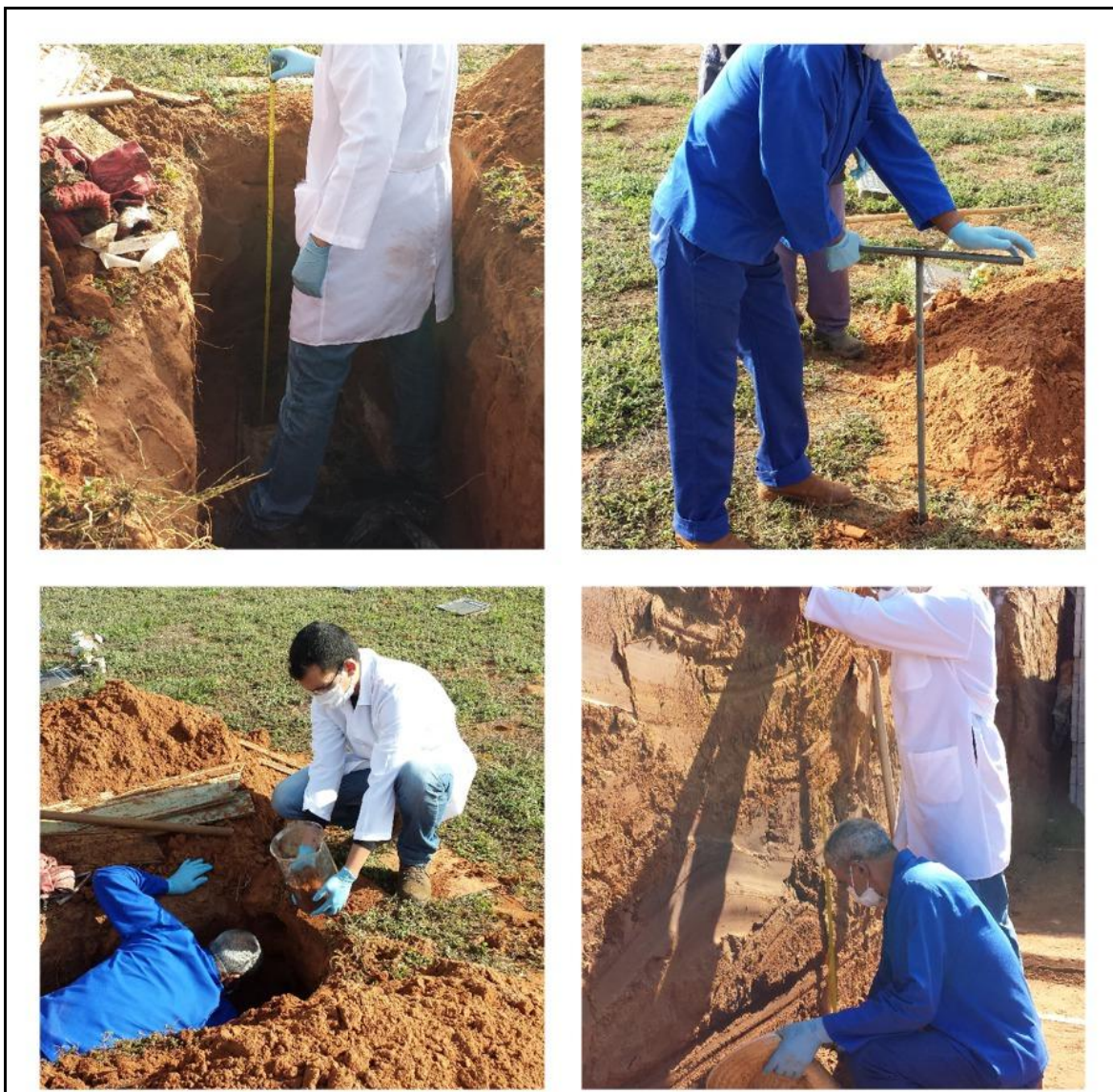
Figura 12 - Procedimento de coleta de amostras de solo em local com atividade cemiterial, Cemitério Jardim - Botucatu - SP
