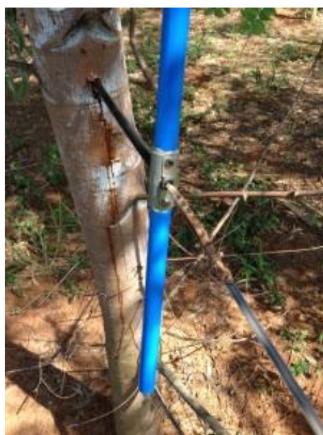
Figura 11. Uso da sonda de Pressler na amostragem não destrutiva para determinação de teores de carboidratos não estruturais da madeira de clones de eucalipto
