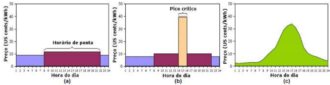
Figura 6 - Comparação entre as três principais modalidades de controle de demanda baseados em tarifas horárias de energia. (a) tarifas para os horários de ponta e fora de ponta; (b) tarifas de pico crítico; (c) tarifas em tempo real.
