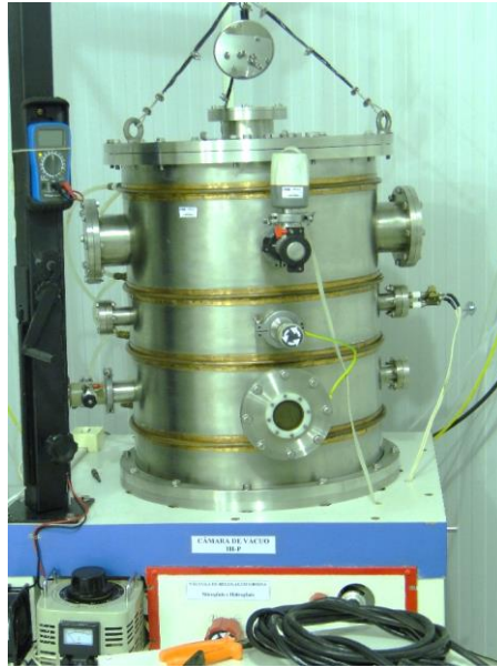
Figura 15 - Equipamento tratamento 3IP (câmara de vácuo).
