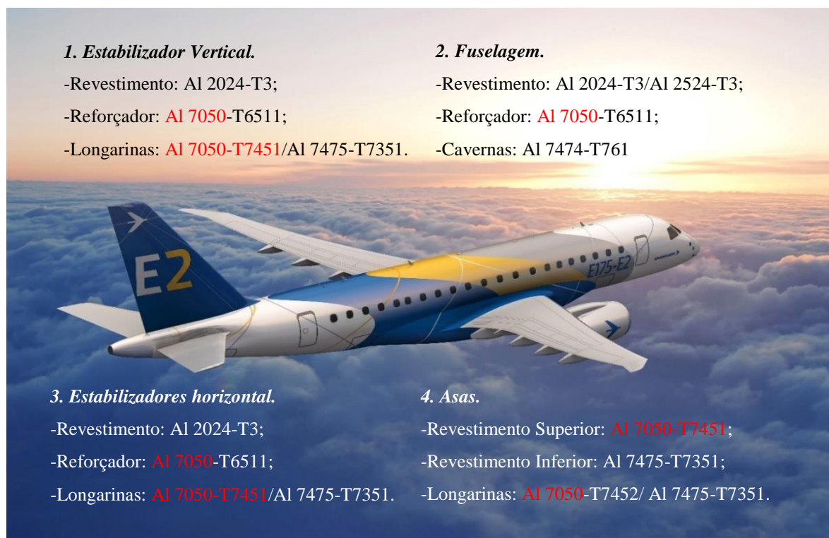
Figura 1 - Aeronave com identificação das ligas de alumínio utilizadas em sua fabricação.
