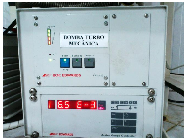
Figura 16 - Bomba de vácuo acoplada na câmara de tratamento.
