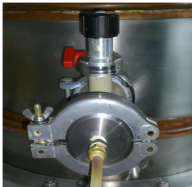
Figura 18 - Válvula de pressurização.
