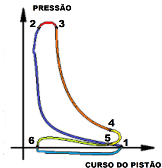
Figura 7 – Esboço diagrama indicado de um motor Diesel de quatro tempos.
