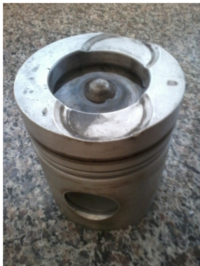
Figura 8 – Foto do pistão e câmara de combustão sendo preenchida com água.
