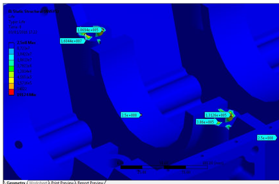
Figura 43 – Bloco – Análise de fadiga – Rosca do mancal.
