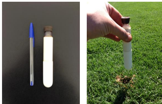
Figura 7. Extrator de solução do solo desenvolvido para gramados esportivos.
