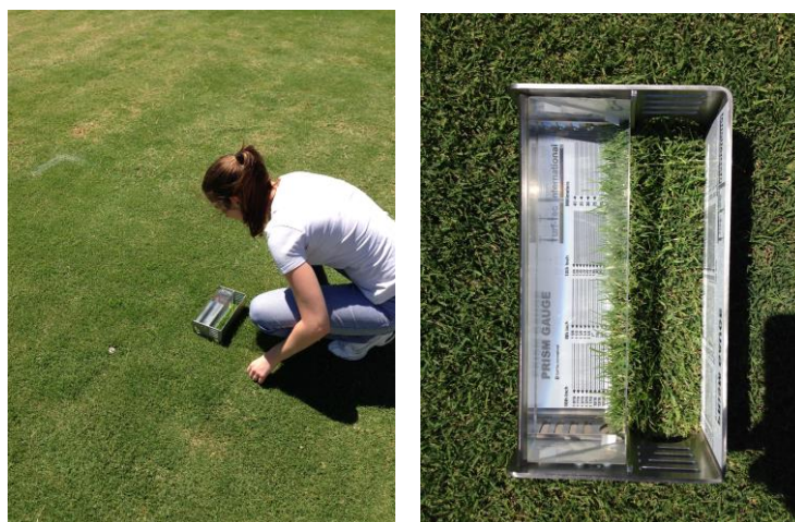
Figura 10. Aparelho “Grass Height Prism Gauge” para avaliação da altura do gramado.
