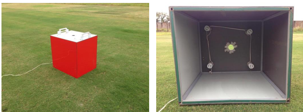
Figura 13. “Light box” utilizada para padronizar a luminosidade das fotos.
