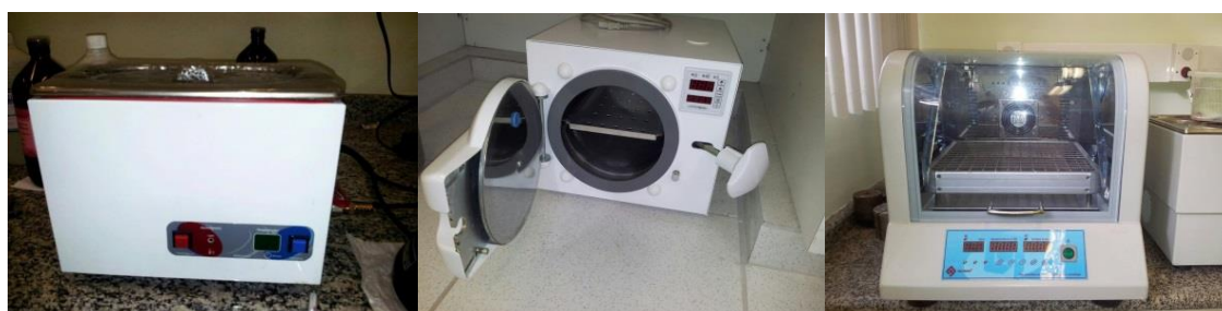
Figuras 10. Aparelhos utilizados no tratamento hidrotérmico (a) banho maria (b) autoclave (c) mesa agitadora
