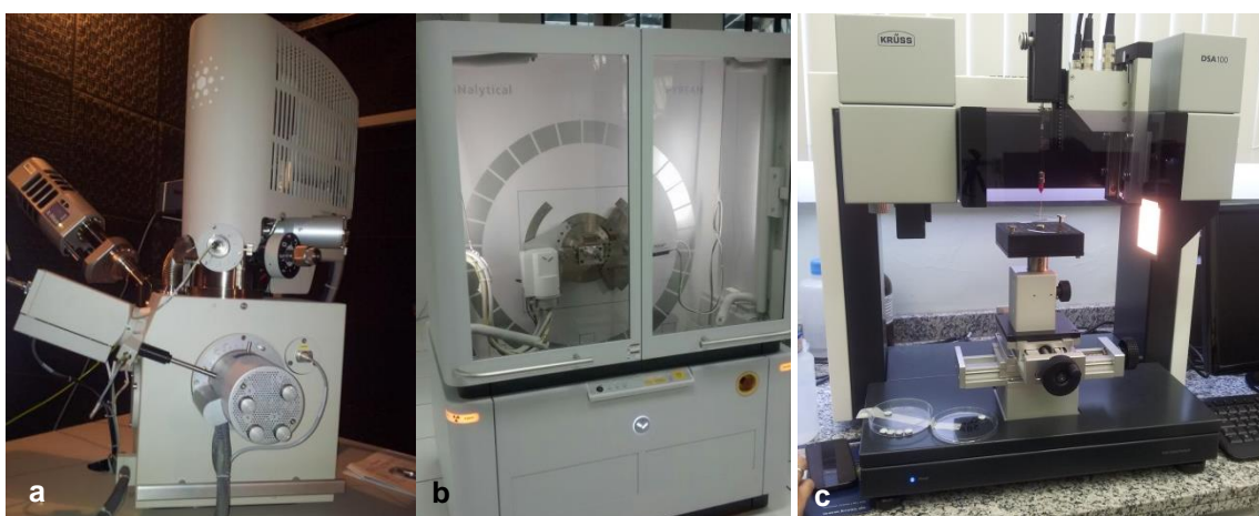
Figura 12. Aparelhos para análise (a) Microscópio Eletrônico de Varredura (b) Difratorômetro de raios X (c) Medidor de ângulo de contato
