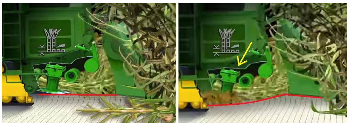
Figura 3. Contato entre o corte de base e o solo (Direita) devido à falta de acompanhamento do perfil do solo pelo corte de base controlado manualmente em terreno com ondulações (Fonte: John Deere).
