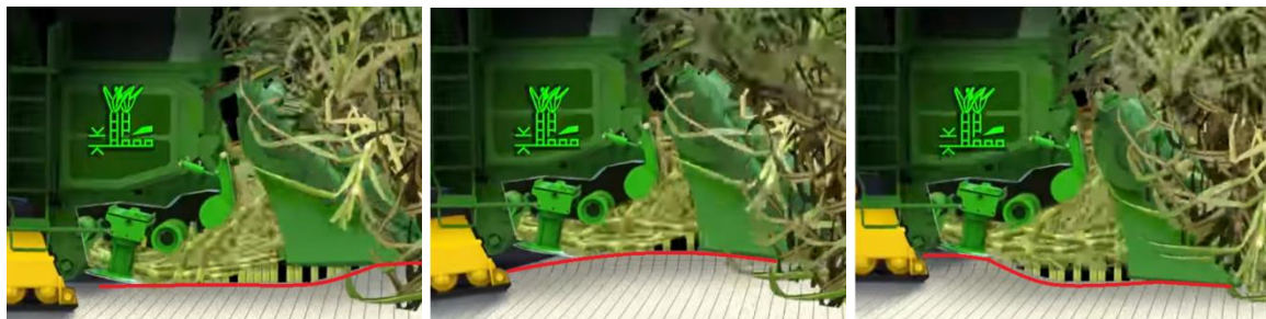
Figura 5. Detalhe do acompanhamento automático do perfil do solo pelo corte de base sinal recebido do divisor de linhas (Fonte: John Deere).
