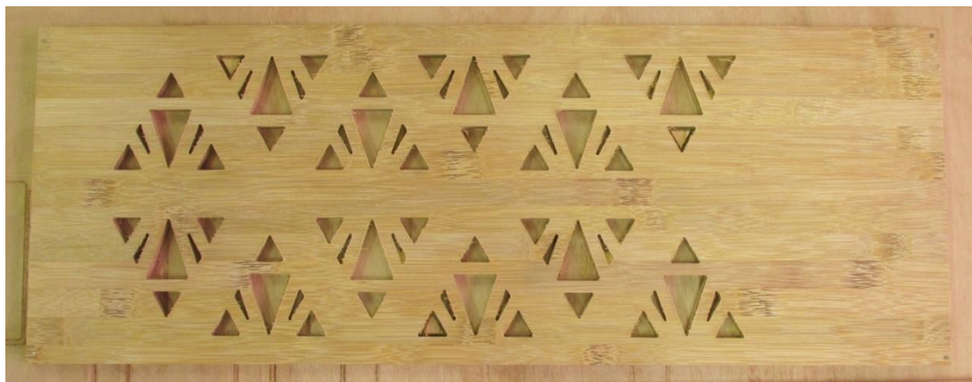
Figura 161 - Placa com a primeira etapa concluída: usinagem dos detalhes internos das peças
