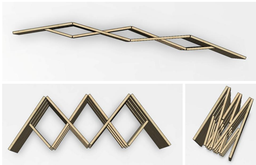
Figura 129- Observação da vista superior da estrutura montada, do seu movimento de abertura e fechamento
