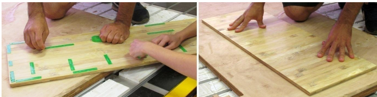
Figura 131 - Fixação da fita VHB nas placas e na mesa
