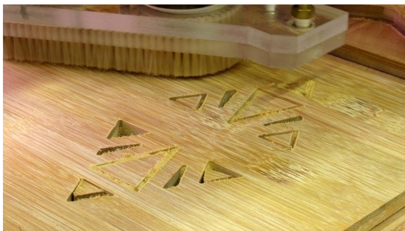
Figura 160 - Usinagem dos detalhes internos do modelo
