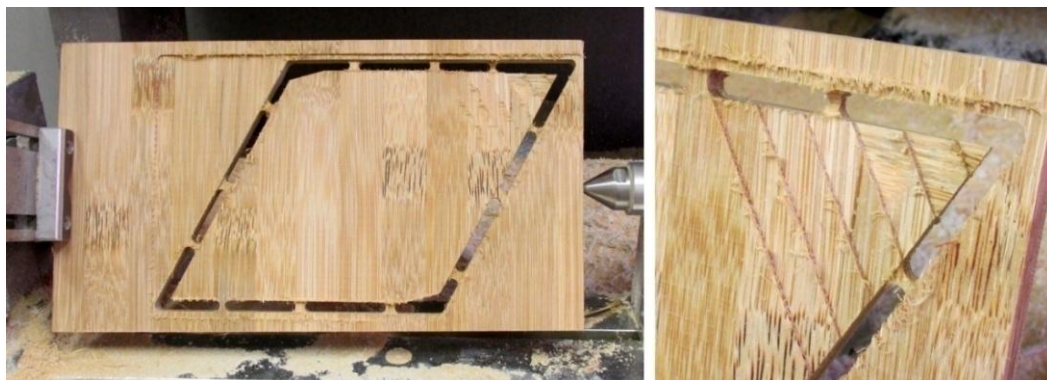
Figura 187 - Face 2 da peça ao final do desbaste (esq.) e detalhe do chanfro (dir.)
