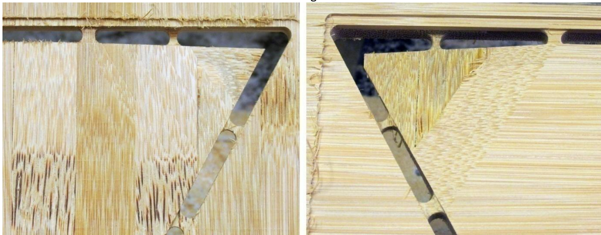
Figura 189 - Detalhe dos dois chanfros com acabamento finalizado: o da direita se quebrou durante o processo de usinagem
