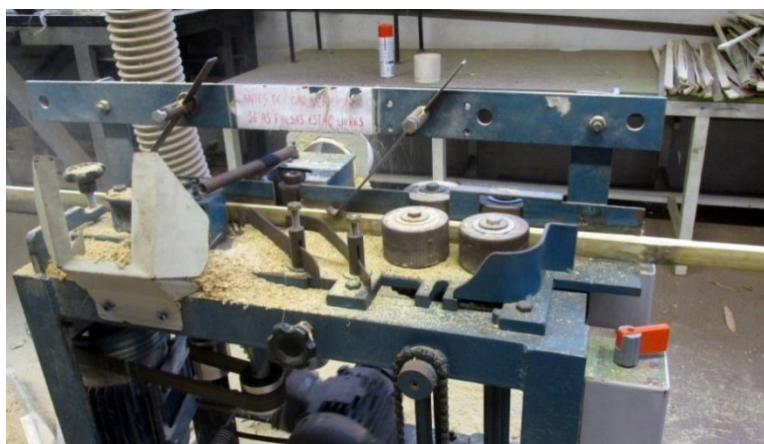
Figura 113 - O processamento da ripa na plaina duas faces
