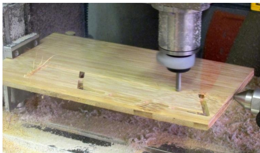
Figura 185 - Usinagem da superfície posterior e correção de defeitos da placa
