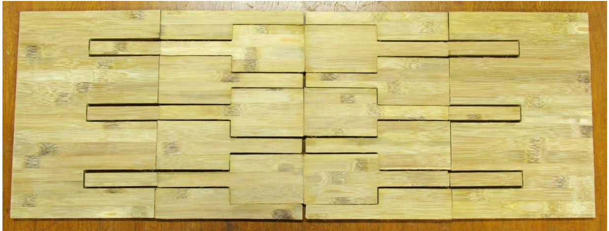
Figura 135 - Montagem prévia do modelo antes de iniciar a fixação das dobradiças
