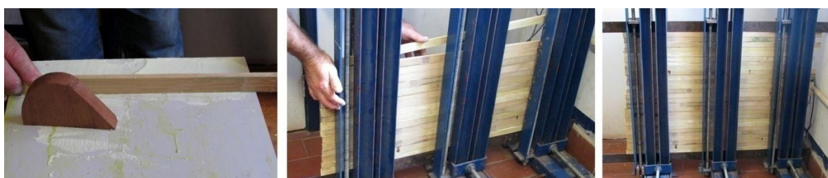
Figura 114 - Colagem e prensagem das ripas laminadas
