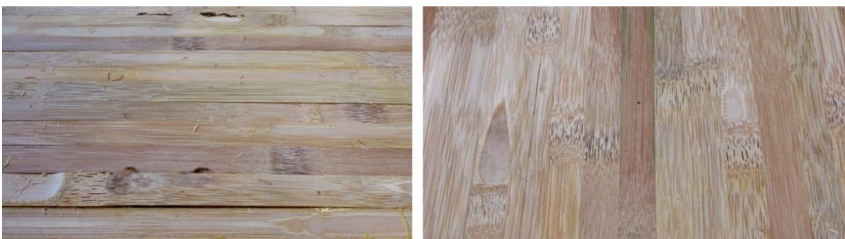
Figura 116 - As placas antes e depois de passarem na plaina desengrossadeira
