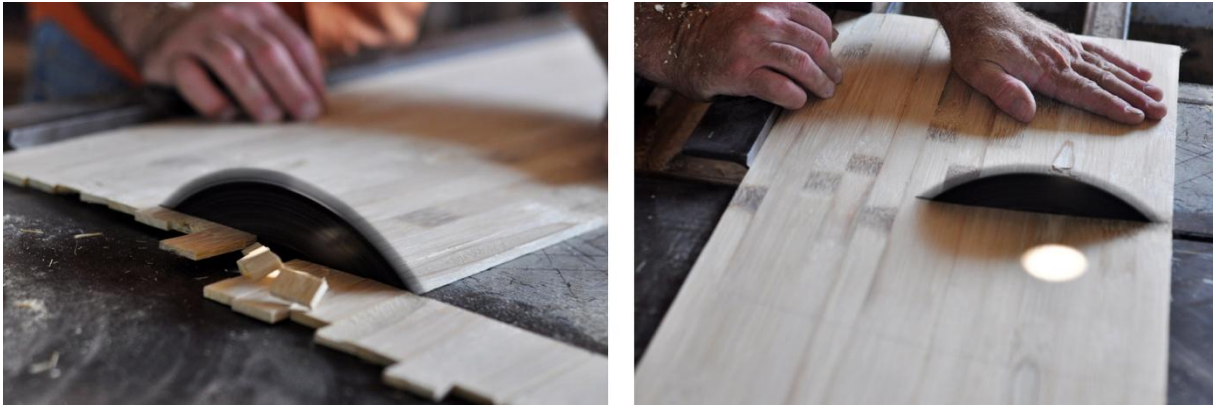
Figura 117 - Corte na serra circular de bancada para ajustes
