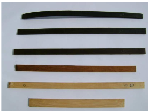
Figura 11 - Ripas de bambu termorretificado (BTR), organizados de acordo com a temperatura de tratamento térmico (de cima para baixo): 300°C, 260°C, 220°C, 180°C, 140°C e controle (seco ao ar)
