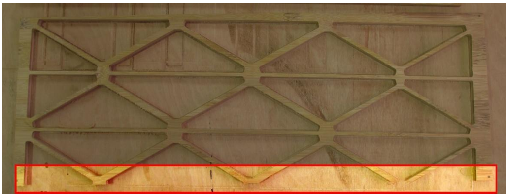
Figura 150 - Destaque da usinagem incorreta na última linha de peças
