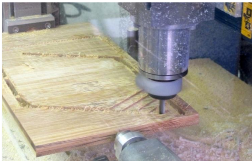
Figura 184 - Usinagem da peça com chanfro: desbaste de uma superfície
