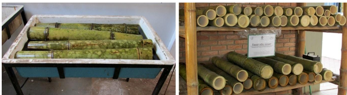
Figura 108 - Colmos no tanque para tratamento preventivo e secagem
