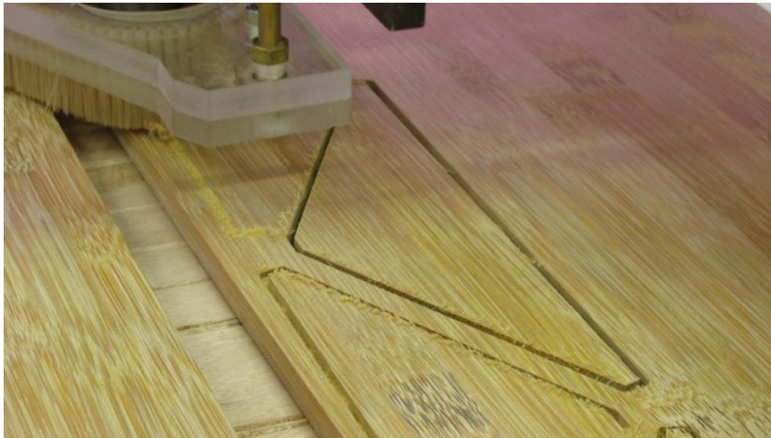
Figura 149 - Usinagem com a fresa nova: melhor acabamento
