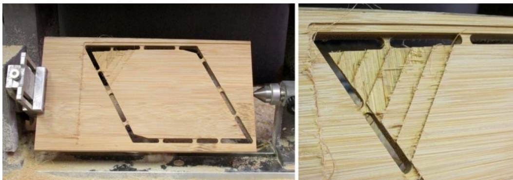
Figura 186 - Face 1 da peça ao final do desbaste (esq.) e detalhe do chanfro (dir.)
