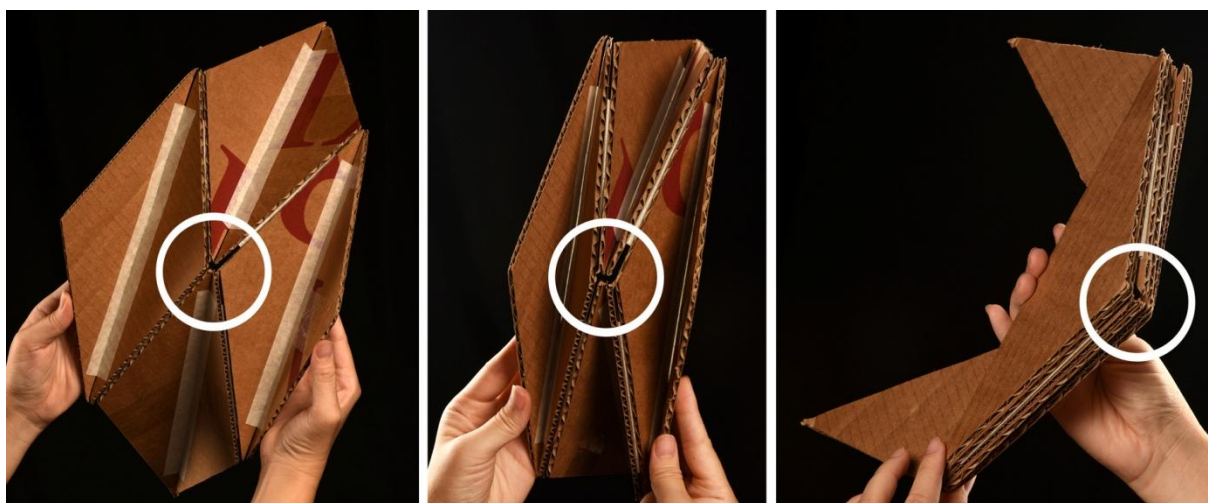
Figura 144 - Ponto crítico (em destaque) na dobra do Padrão Yoshimura durante o movimento de fechamento
