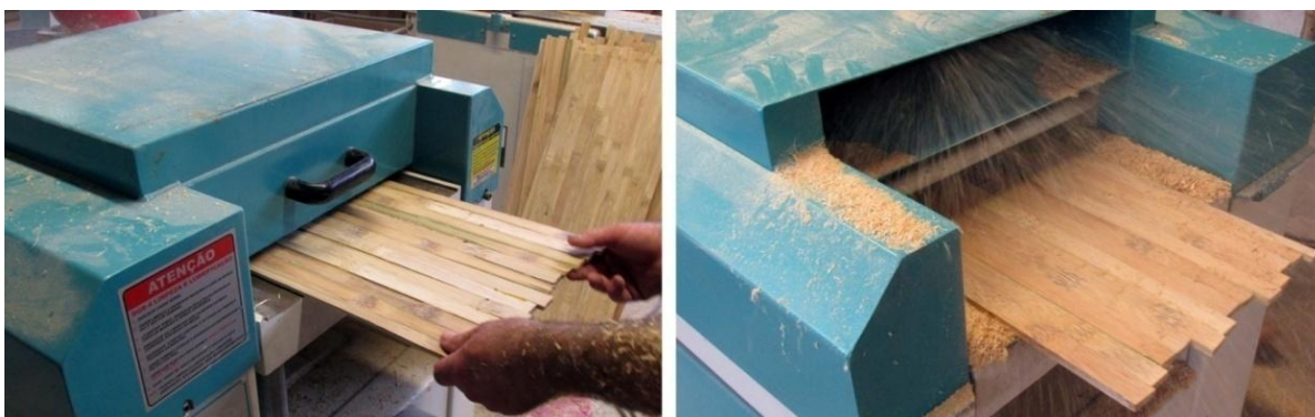
Figura 115 - Entrada da placa de desengrossadeira (esquerda) e sua aplainagem (direita)
