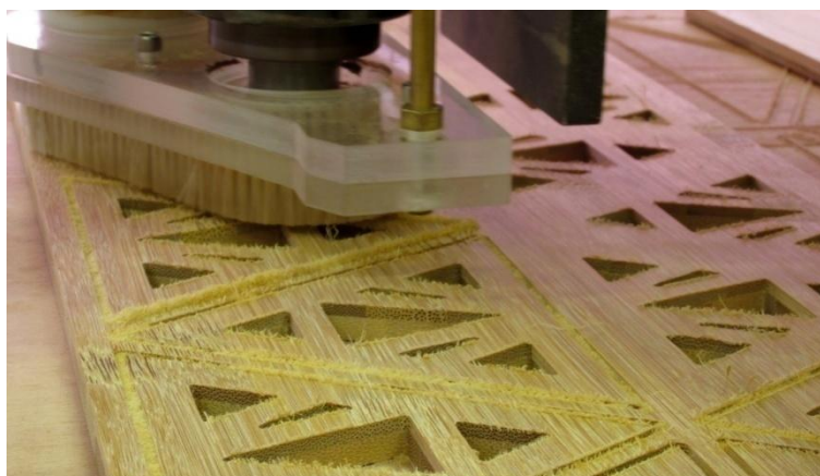
Figura 162 - Usinagem da parte externa das peças
