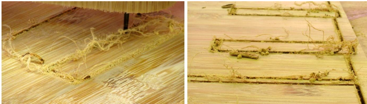
Figura 132 - Acabamento da usinagem com fresa usada
