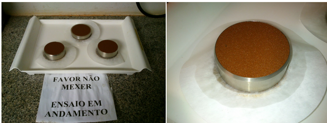
Figura 27 – Aspecto do corpo de prova no processo de saturação.
