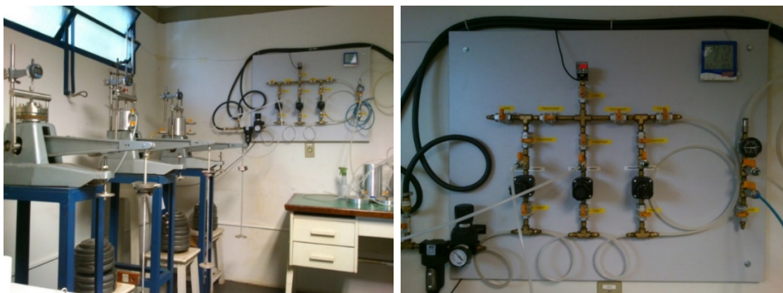
Figura 34 – Prensas edométricas existentes no laboratório e painel de controle de ar comprimido.
