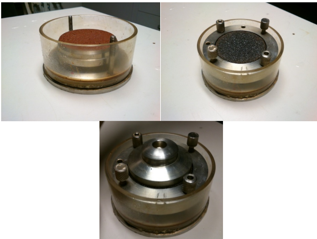
Figura 28 – Montagem do edômetro convencional.
