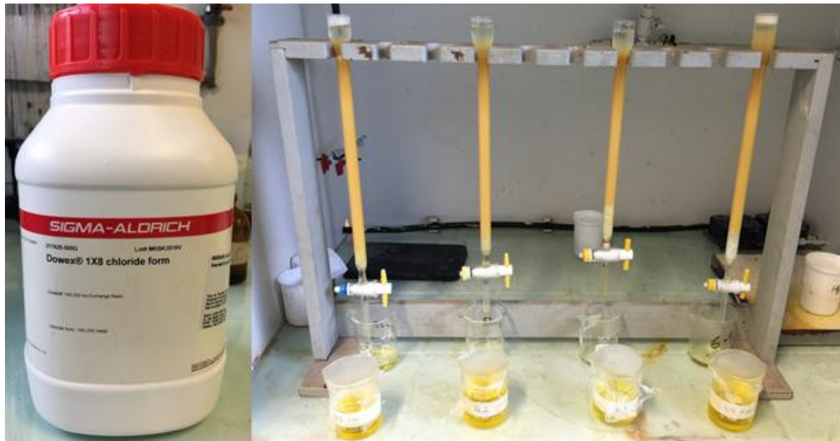
Figura 23 - Resina Dowex 1-X8 e sua inserção em colunas.
