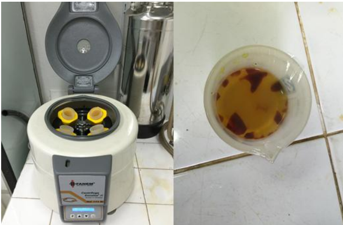
Figura 21 - Amostras de água dispostas na centrífuga para a recuperação do precipitado e a dissolução deste precipitado com HCl (8M), respectivamente.
