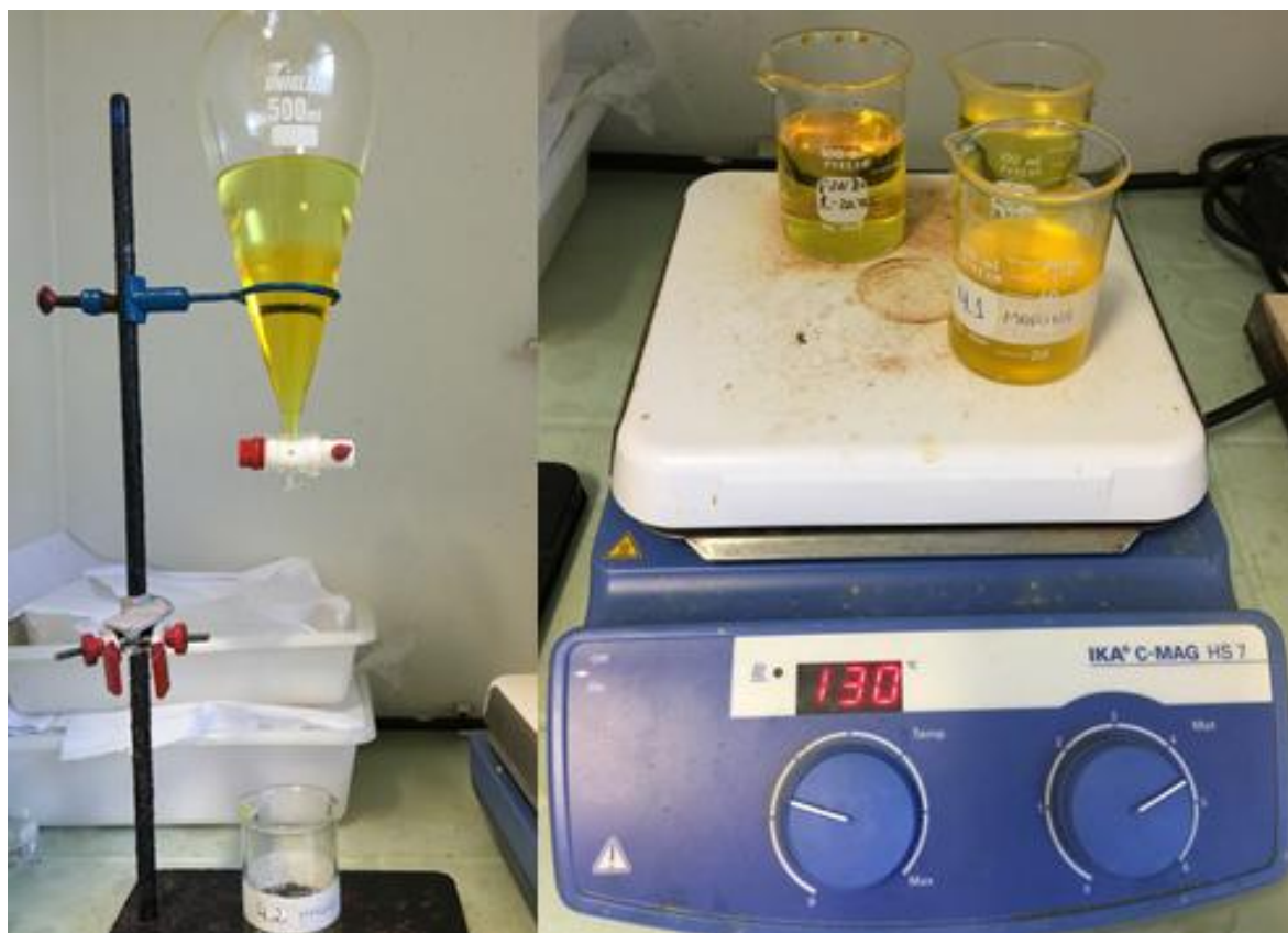
Figura 22 - Extração do ferro com solvente orgânico (éter etílico), onde o ferro passa da solução ácida para o éter e evaporação da camada ácida contendo urânio, respectivamente.
