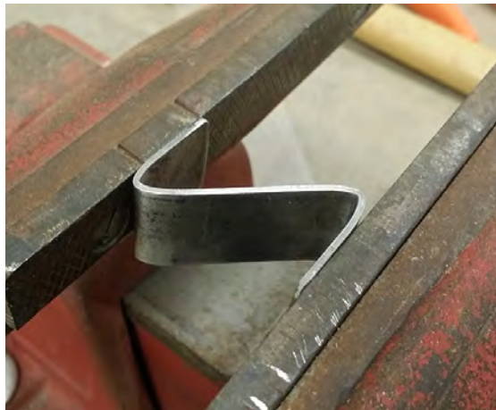
Fig.114: Gancho dobrado na morsa (Fonte: das Autoras)
