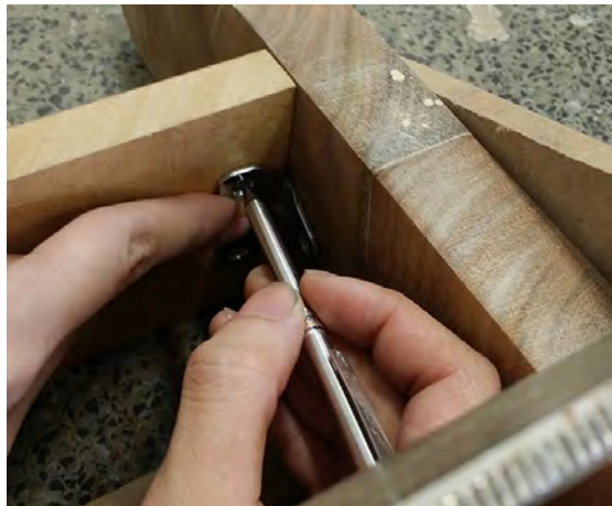
Fig.110: Marcação do furo para fixar a cantoneira (Fonte: das Autoras)
