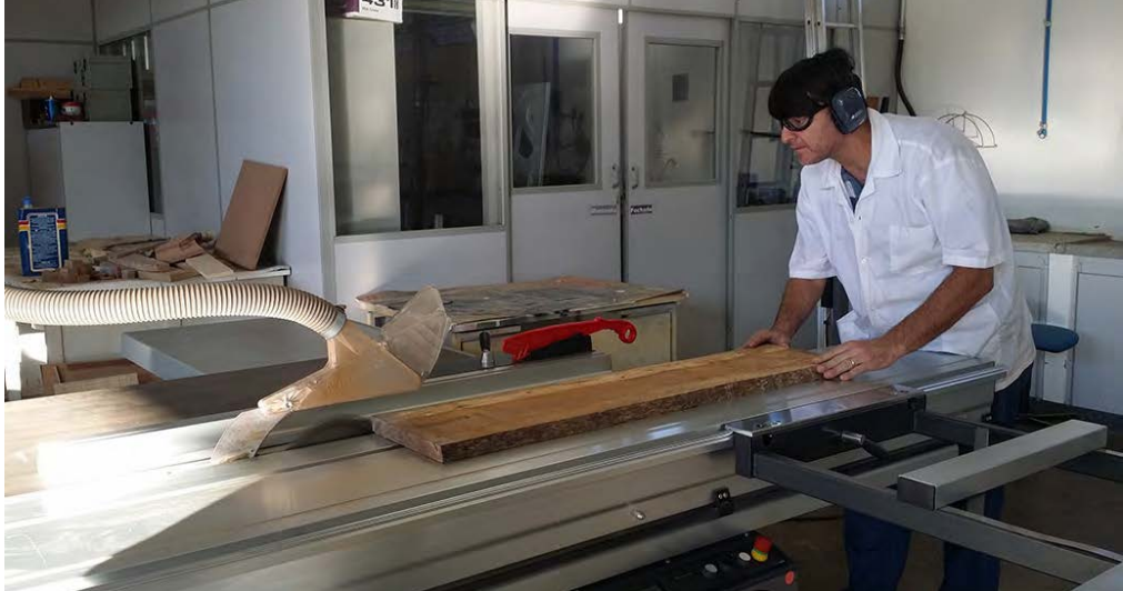
Fig.87: Retirada de uma das laterais na esquadrejadeira (Fonte: das Autoras)
