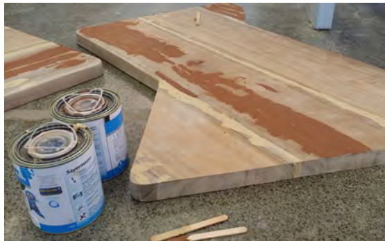
Fig.119: Aplicação de massa (Fonte: das Autoras)
