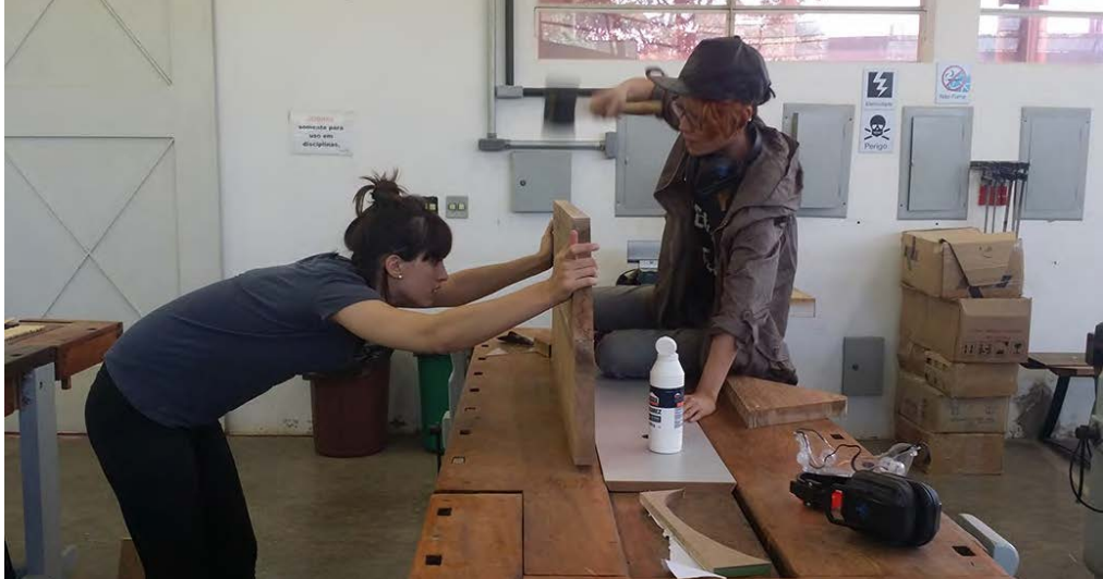
Fig.101: Empilhamento do plano da lateral da poltrona (Fonte: das Autoras)
