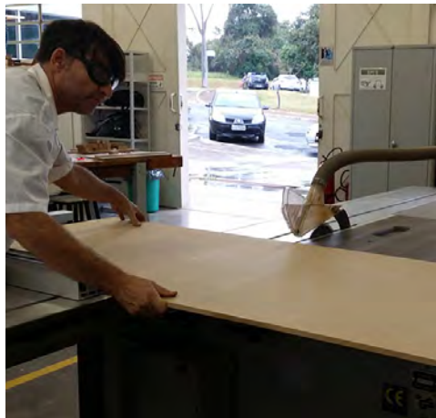
Fig.95: Corte do MDF na esquadrejadeira (Fonte: das Autoras)
