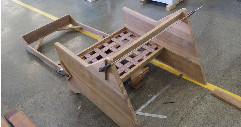
Fig.112: Pré-montagem da poltrona - calços e sargentos (Fonte: das Autoras)
