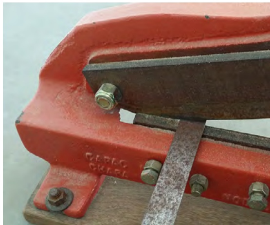
Fig.116: Corte do metal na guilhotina (Fonte: das Autoras)
