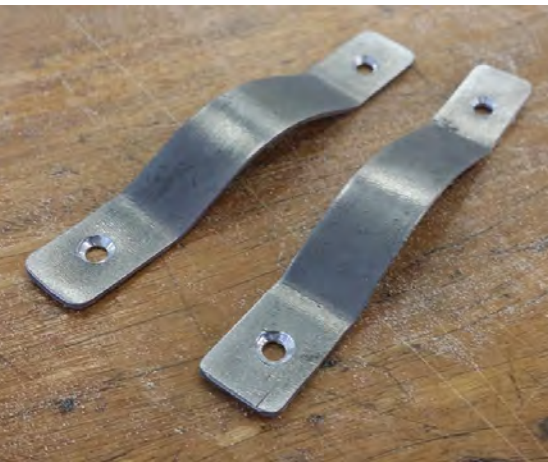
Fig.115: Ferragens usinadas (Fonte: das Autoras)
