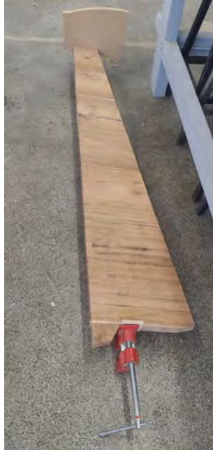
Fig.103: Aperto com o auxílio de sargento (Fonte: das Autoras)
