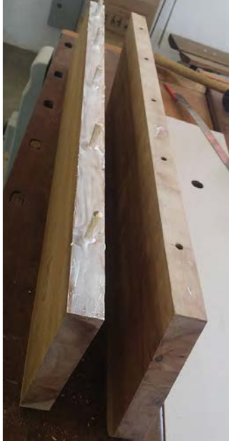
Fig.102: Empilhamento com cavilhas e cola (Fonte: das Autoras)
