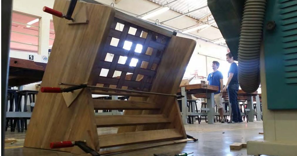
Fig.113: Pré-montagem para marcar o posicionamento das cantoneiras (Fonte: das Autoras)
