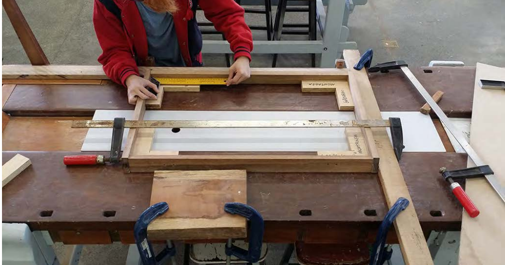
Fig.107: Esquadreamento do caixote da poltrona (Fonte: das Autoras)
