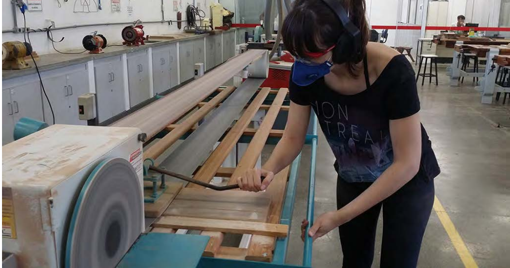
Fig.94: Lixadeira de cinta - ajuste da espessura das peças (Fonte: das Autoras)
