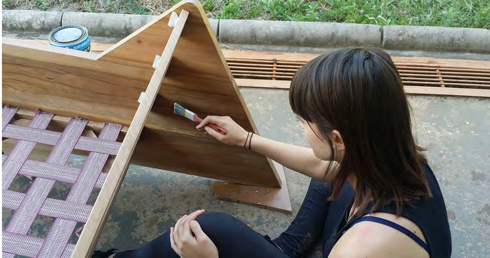
Fig.122: Aplicação do verniz (Fonte: das Autoras)
