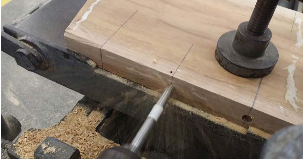
Fig.100: Furadeira horizontal - furo para posicionamento das cavilhas (Fonte: das Autoras)
