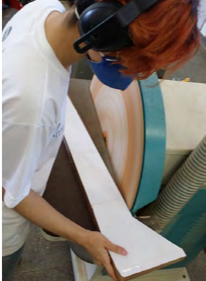
Fig.93: Ajustando dimensões da peça na lixadeira de disco (Fonte: das Autoras)
