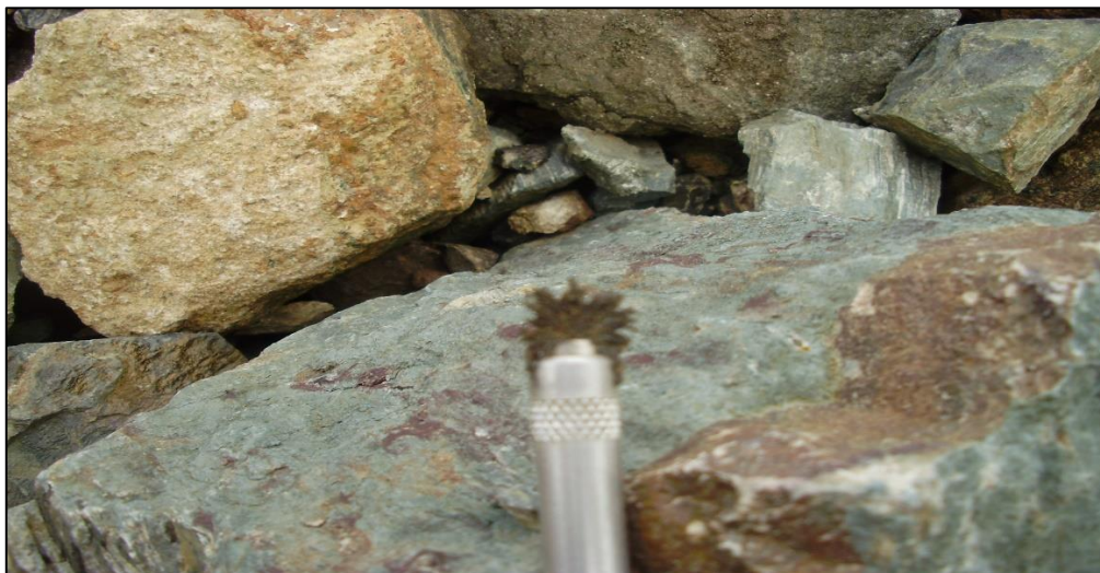
Figura 5.5.1.1.1. – Foto demonstrando grande volume de magnetita atraída por “caneta imã” utilizada no trabalho.
