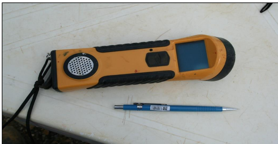
Figura 5.5.2.1. – É demonstrado o Susceptibilímetro Magnético KT-10 utilizado no método.
