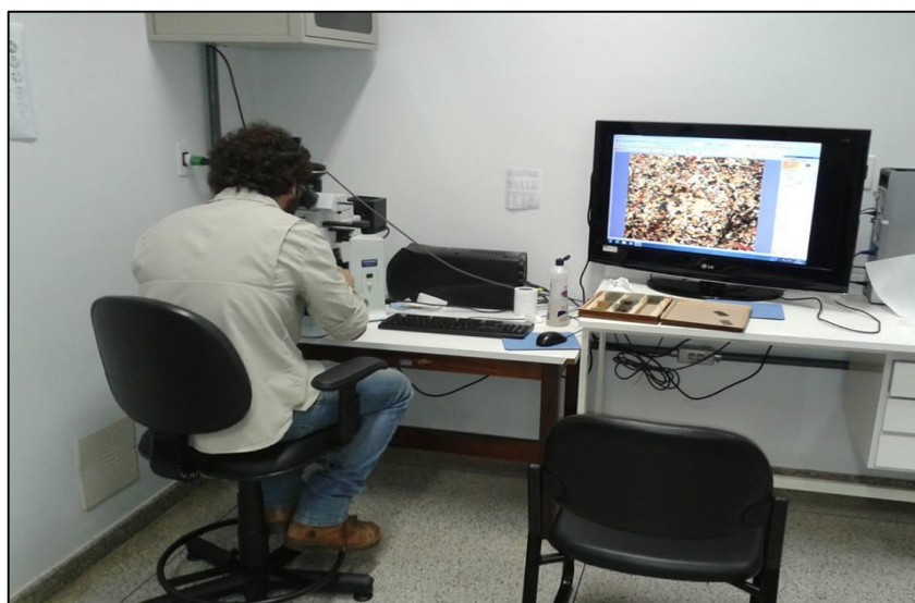
Figura - 5.2.2.1. Foto demonstrando a etapa de descrição petrográfica das lâminas delgadas dos sete litotipos de rocha no laboratório de microscopia do IESA da UFG.
