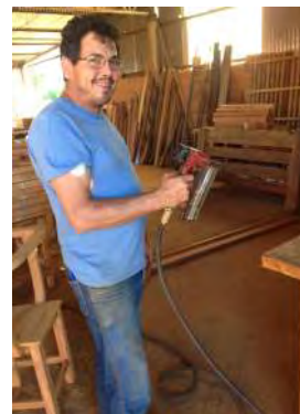
Após encaixar os pés com cavilhas, estes também foram reforçados com pregos. A foto ao lado mostra a pneumática de pregos.
