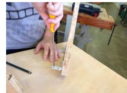
Furo com a furadeira manual e parafuso com uma chave de fenda prendendo as cantoneiras aos pés e depois ao tampo.
