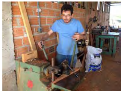
Furos foram feitos para colocar cavilhas de encaixe nos pés.
