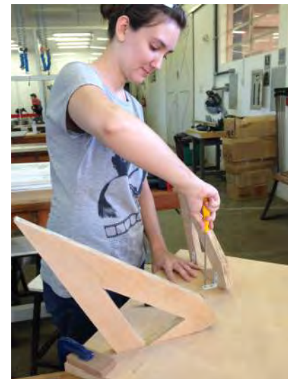
Furo com a furadeira manual e parafuso com uma chave de fenda prendendo as cantoneiras aos pés e depois ao tampo.
