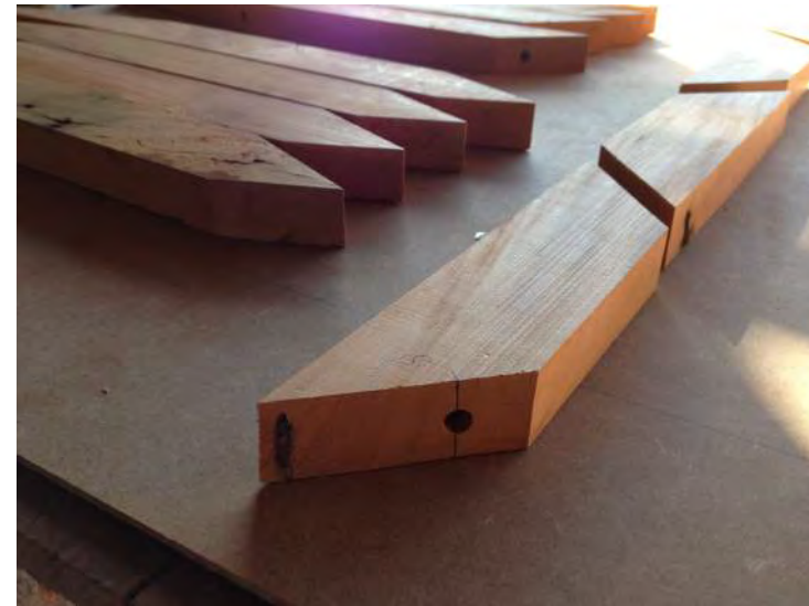
Após encaixar os pés com cavilhas, estes também foram reforçados com pregos. A foto ao lado mostra a pneumática de pregos.
