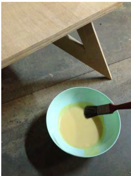
Passei uma camada de verniz a base de água e deixei secar durante a noite.
