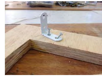
Furo com a furadeira manual e parafuso com uma chave de fenda prendendo as cantoneiras aos pés e depois ao tampo.
