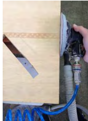
Espero secar, e começo a lixar, usando uma lixadeira pneumática. Lixas números: 100, 220 e 320.
