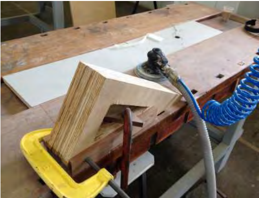
Espero secar, e começo a lixar, usando uma lixadeira pneumática. Lixas números: 100, 220 e 320.
