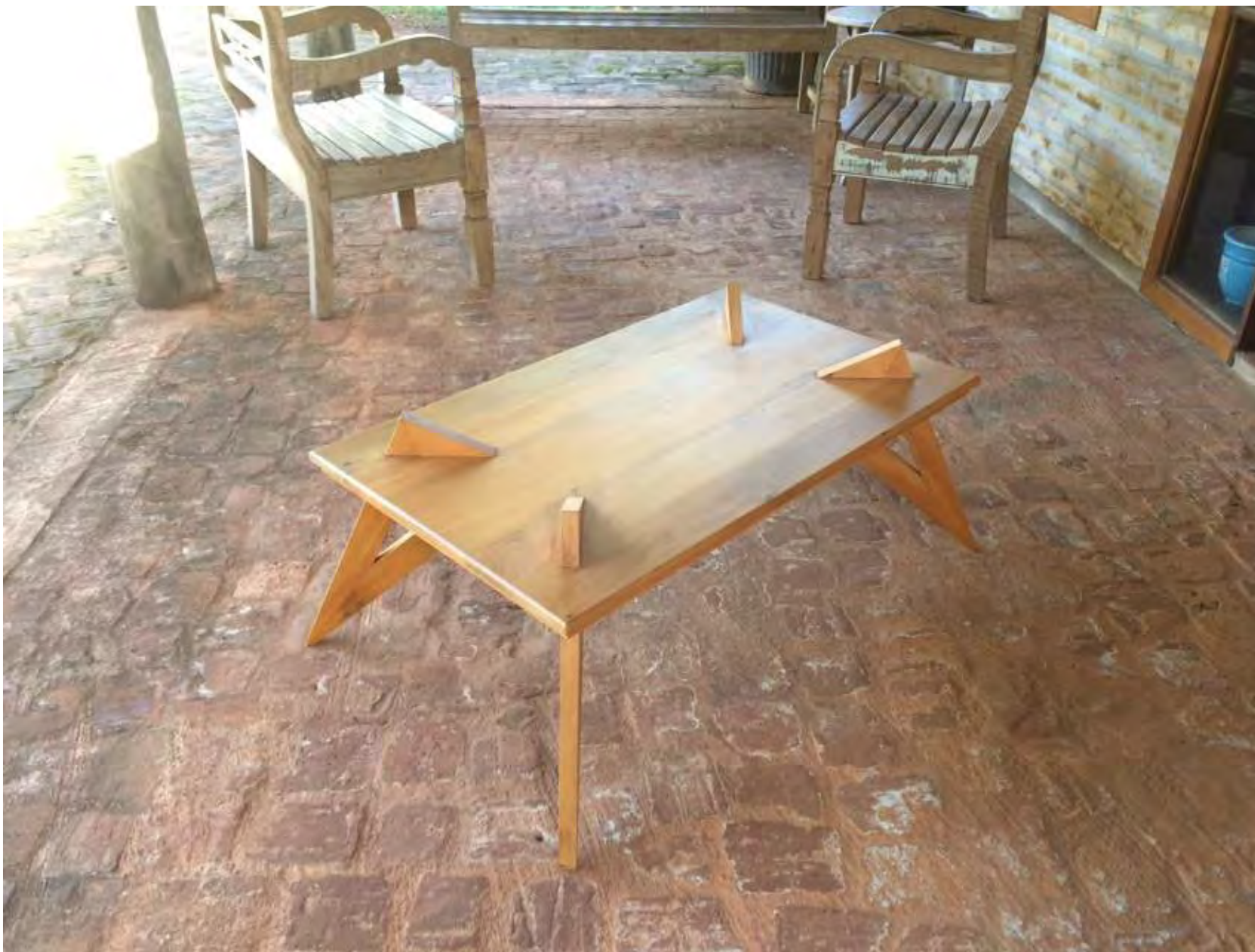
Enquanto eu finalizava uma mesa em compensado, Sr. Nenê finalizava a outra em madeira de demolição. Foi passado um selador e a mesa foi polida.
