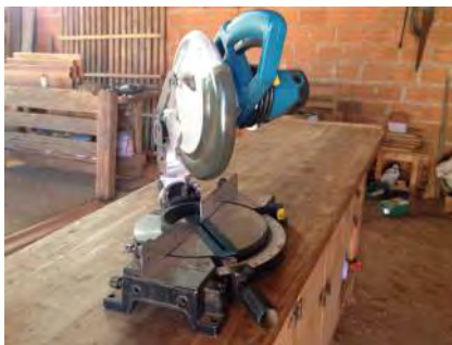
Os cortes em ângulos foram feitos na serra circular Makita.
