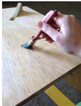
Na manhã seguinte poli com uma lixa 400 e passei a segunda camada de verniz.
