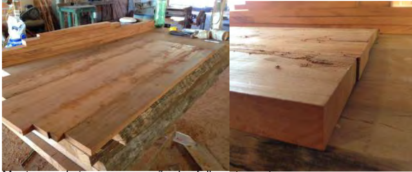
Montagem do tampo e correção das falhas da madeira com uma massa especial.
