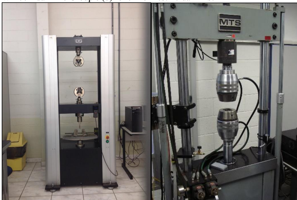
Figura 24 – Máquinas utilizadas para obtenção dos resultados do ensaio de tração. (a) - WDW-100B da Time Group e (b) -810-FlexTest 40 da MTS.
