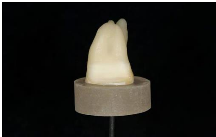
FIGURA 16 – Vedamento do fragmento no suporte acrílico e cânula com cianoacrilato
