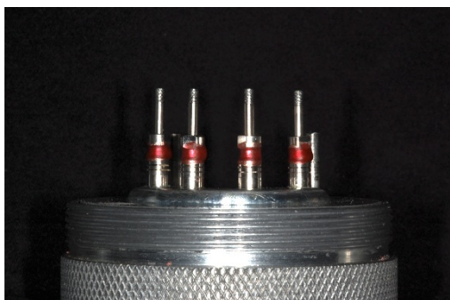
Figura 12 – Aspecto da matriz de análogos retos após a união com os bastões de resina acrílica;
