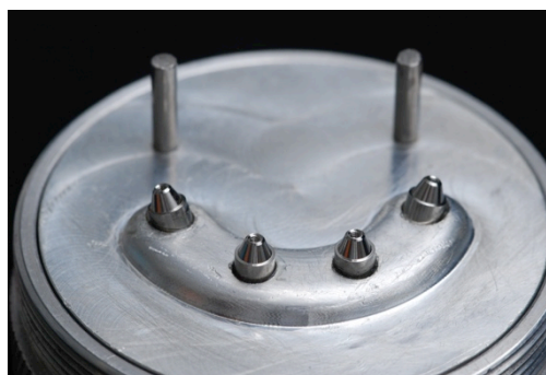
Figura 5 – Aspecto da matriz metálica com análogos distais angulados
