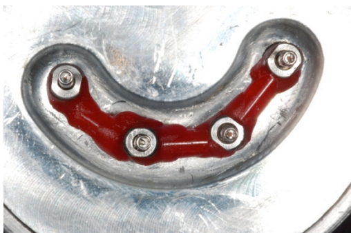
Figura 16 – Aspecto da resina após o seccionamento com disco diamantado
