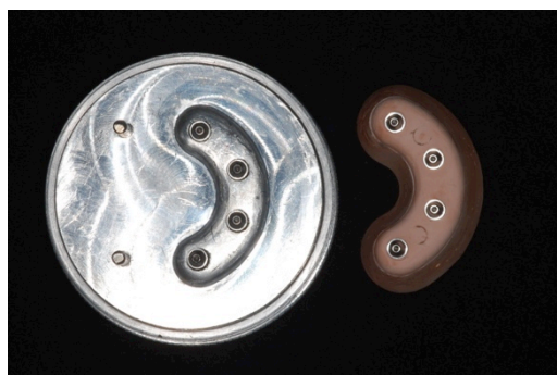
Figura 33 – Aspecto do corpo de prova, ao lado da matriz, após ser removido do dispositivo para vazamento.
