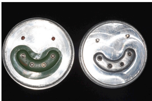
Figura 28 – Aspecto da matriz separada da “moldeira”, após a polimerização do material de moldagem
