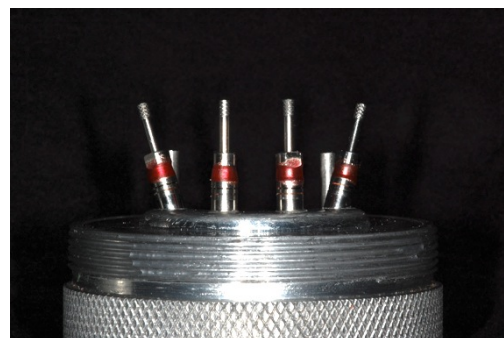
Figura 13 – Aspecto da matriz de análogos distais angulados após a união com os bastões de resina acrílica.
