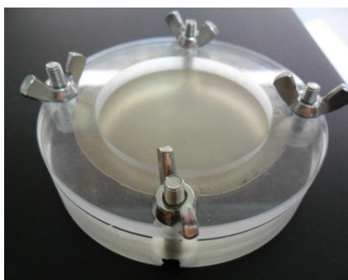
Figura 9 - Célula contendo o filme utilizada para as medidas de permeabilidade ao vapor de água
