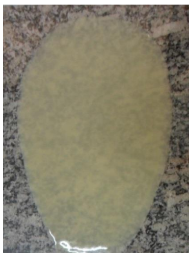
Figura 8 - Fotografia digital da solução filmogênica contendo pectina, polpa de cacau e nanopartículas em processo de secagem
