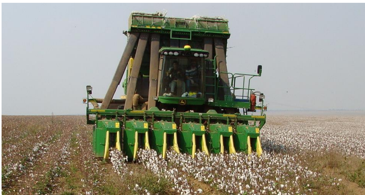
Figura 2. Colhedora de algodão com plataforma do tipo picker .
