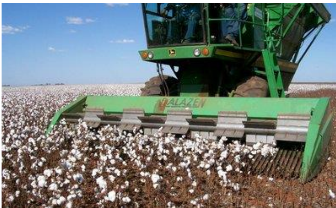
Figura 1. Colhedora de algodão com plataforma de colheita tipo stripper .
