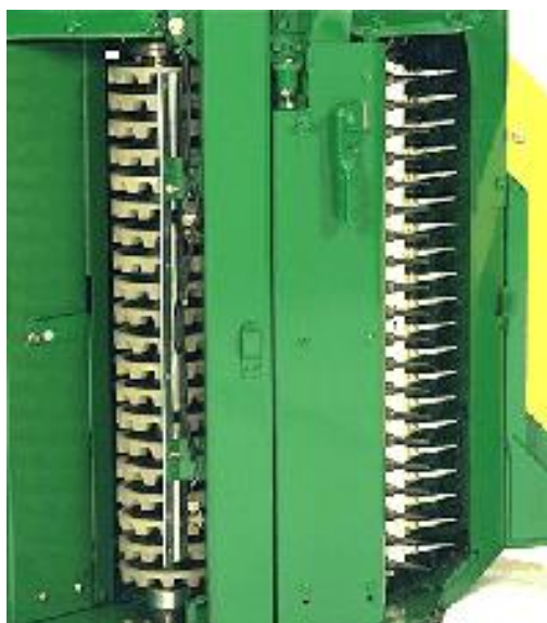
Figura 3. Destaque para o sistema de colheita tipo picker , a direita fusos e desfibradores de borras, a esquerda destaque para o formato do fuso (JOHN DEERE, 2016).
