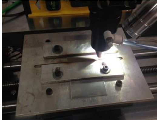
Figure 16 Dispositivo de fixação da junta para a soldagem laser
