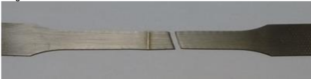
Figura 38 Foto do CP fraturado evidenciando a fratura no metal base.
