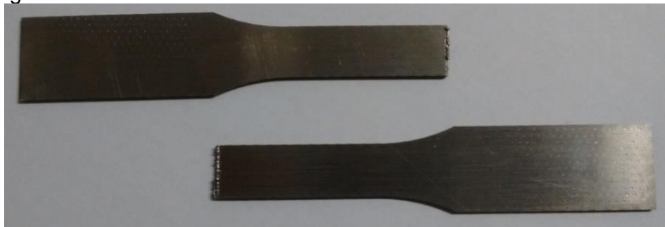
Figura 42 Foto do CP 40% evidenciando a fratura no cordão de solda.
