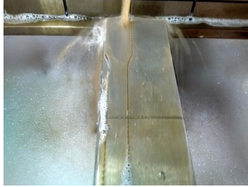
Figura 24 Corpo de prova sendo confeccionado na eletroerosão.
