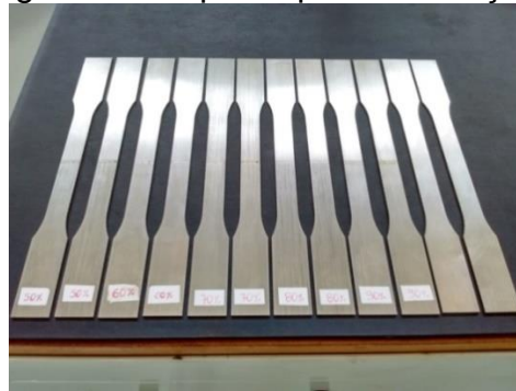
Figura 22 Corpo de prova de tração.
