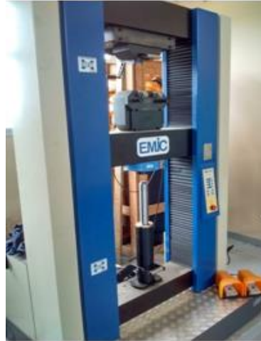
Figura 20 Máquina Universal de Ensaios, EMIC modelo: DL 30.000
