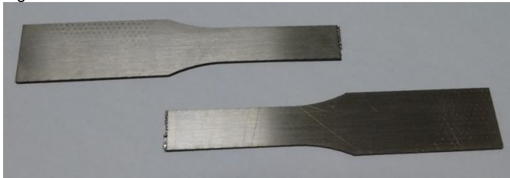
Figura 39 Foto do CP 50/1 evidenciando a fratura no cordão de solda.
