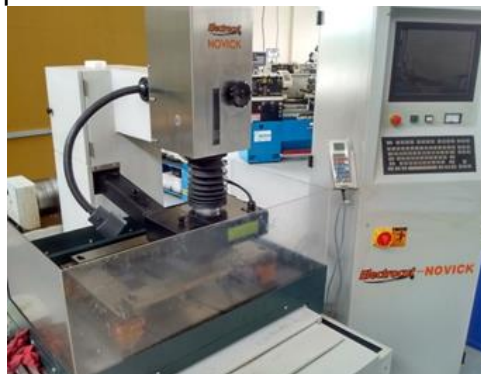
Figura 23 Equipamento de eletroerosão a fio Eletrocut NOVICK.
