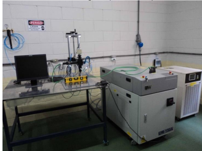
Figura 15 Sistema de soldagem por laser pulsado de Nd: YAG
