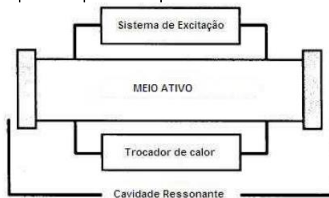
Figura 1 Principais componentes que constituem os sistemas a laser.
