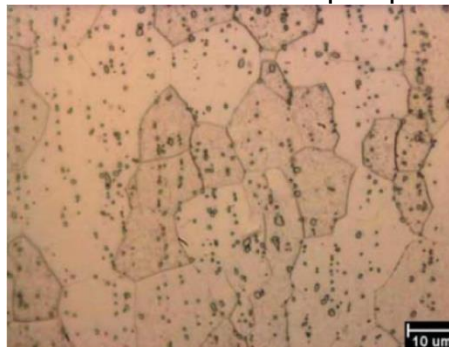
Figura 9 Microestrutura de um aço inoxidável ferrítico. Grãos cristalizados de ferrita com carbonetos de cromo. Ataque químico Vilella
