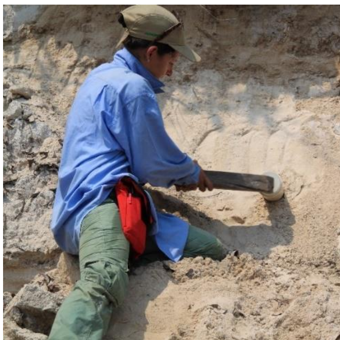
Figura 2.2: Modo de coleta de amostra de sedimento in loco para datação por LOE (Luminescência Opticamente Estimulada) na área de estudo.
