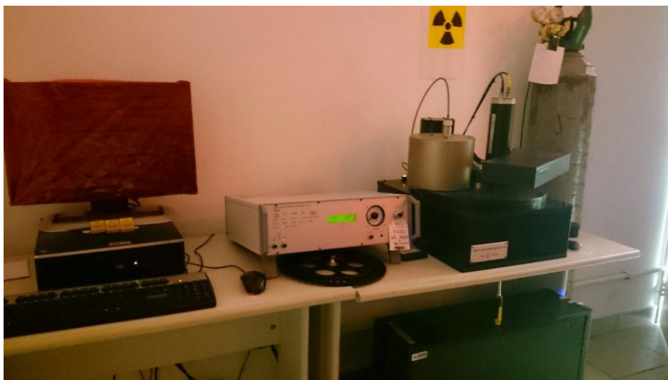
Figura 2.6: Foto do equipamento RISØE TL/OSL Reader, modelo DA-20, Laboratório de Datação, Dosimetria e Análise Multielementares da UNIFESP Campus da Baixada Santista em Santos (SP).
