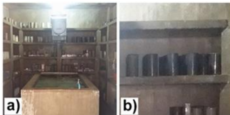
Figura 27 - a) Vista da câmara úmida b) Corpos de prova nas prateleiras
