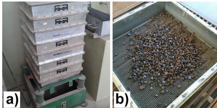
Figura 15 - a) Agitador de agregado; b) Material em uma das peneiras
