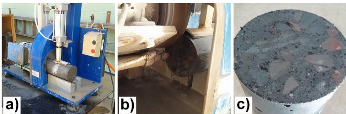
Figura 31 - a) Máquina retificadora; b) Disco polindo corpo de prova; c) Corpo de prova finalizado
