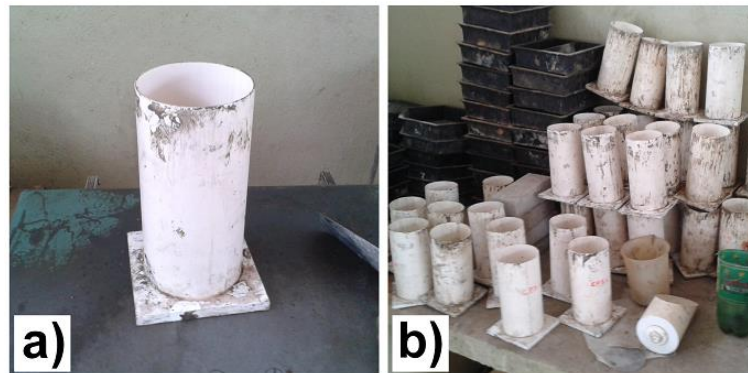
Figura 35 - a) Fôrma cilíndrica de PVC, em detalhe; b) Conjunto de fôrmas utilizadas
