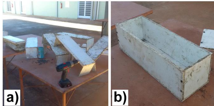
Figura 37 - a) Moldes prismáticos sendo montados para utilização; b) Molde pronto para uso
