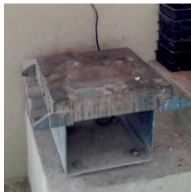
Figura 36 - Mesa vibratória utilizada no laboratório
