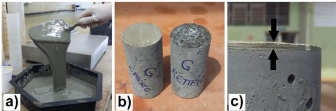
Figura 32 - a) Pasta utilizada na cimentação; b) Corpos de prova após cimentação; c) Detalhe da espessura da cimentação
