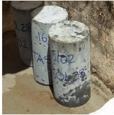
Figura 28 - Corpos de prova curando no sol
