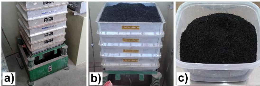
Figura 38 - a) Agitador mecânico; b) Borracha sendo preparada para separação e; c) Resíduo resultante da separação
