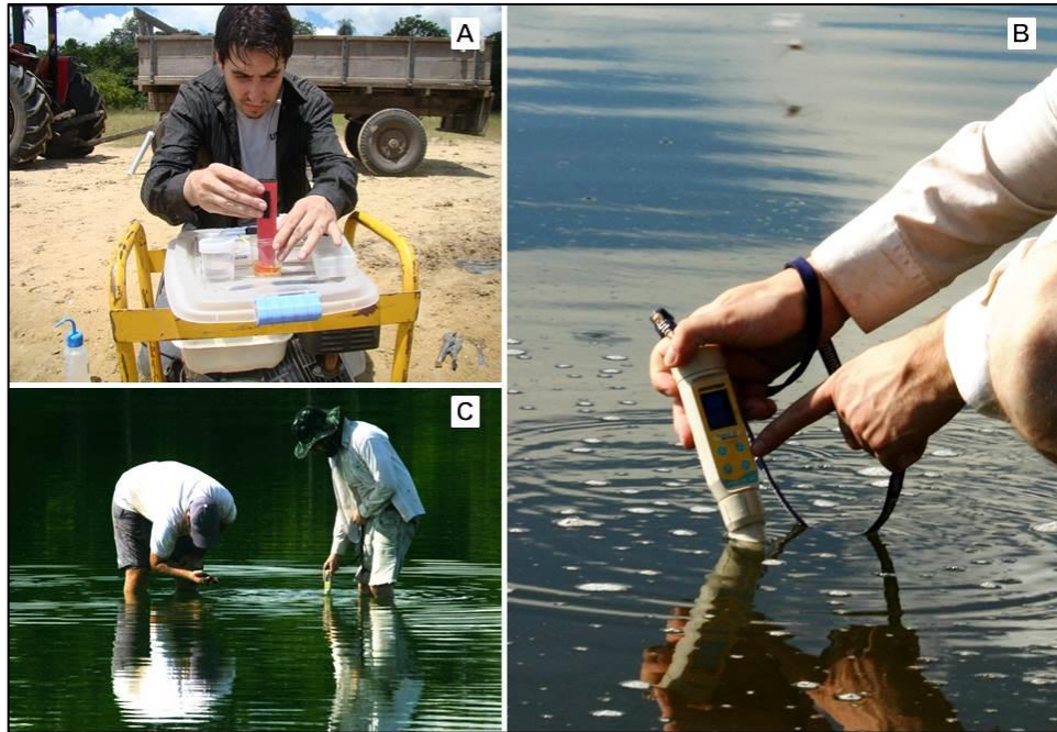
Figura 17. Calibração do equipamento (A) e medição dos parâmetros físico-químicos com sonda multiparâmetro de água digital portátil modelo Oakton PCSTestr 35 nas lagoas salinas (B e C).
