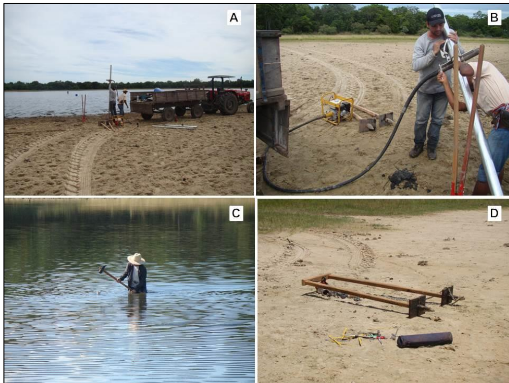
Figura 18. Cenas dos trabalhos de campo. Preparação de equipamento vibrotestemunhador (A e B) e percussão manual com auxílio de marreta para coleta de testemunhos de sondagem nas lagoas salinas (C). Bipé de madeira (D) adaptado com pequenas pranchas, construído especificamente para utilização das lagoas salinas (Fotos: Eder Merino e Hudson Macedo, 2014).
