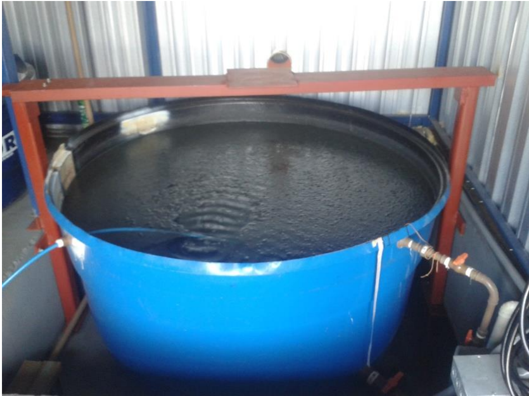
Figura 9: Caixa de 1600 litros com a mistura de efluente suíno com esgoto sanitário
