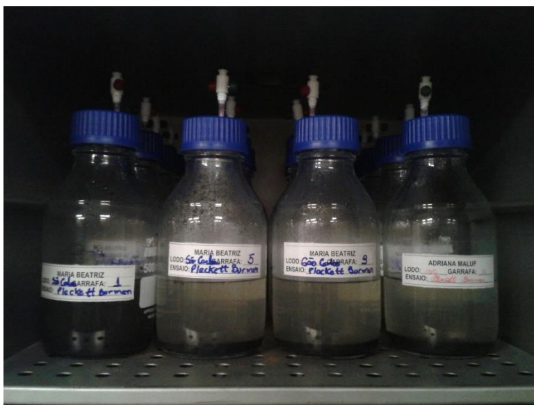
Figura 10: Ensaio em batelada para determinação da AME
