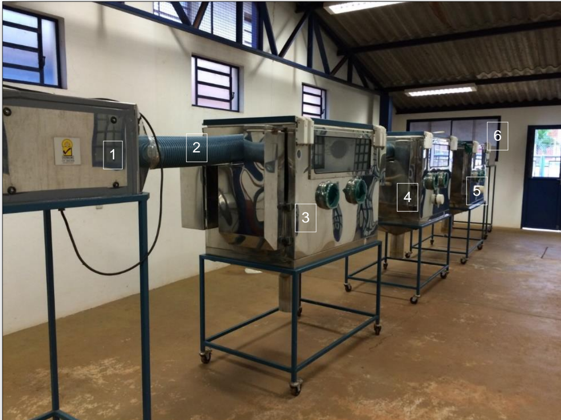
FIGURA 2. Disposição linear dos isoladores para avaliação de transmissão de Clostridium difficile por via aerôgena. (1) Entrada de ar com filtro HEPA; (2) Condutores de ar; (3) Cabine isoladora do grupo Controle; (4) Cabine isoladora do grupo Infectado; (5) Cabine isoladora do grupo Sentinela; (6) Saída de ar com filtro HEPA.
