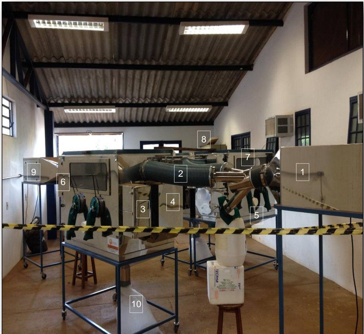
FIGURA 1. Disposição dos isoladores para avaliação de transmissão de Clostridium difficile por via naso-nasal. (1) Entrada de ar com filtro HEPA; (2) Condutores de ar; (3) Caixa de entrada dos leitões, dotada de porta interna e externa; (4) Reservatório para ração; (5) Orifício para conexão com outro isolador (contato naso-nasal); (6) Cabine isoladora do grupo Controle; (7) Cabine isoladora do grupo Sentinela; (8) Cabine isoladora do grupo Infectado; (9) Saída de ar com filtro HEPA; (10) Reservatório para excretas.
