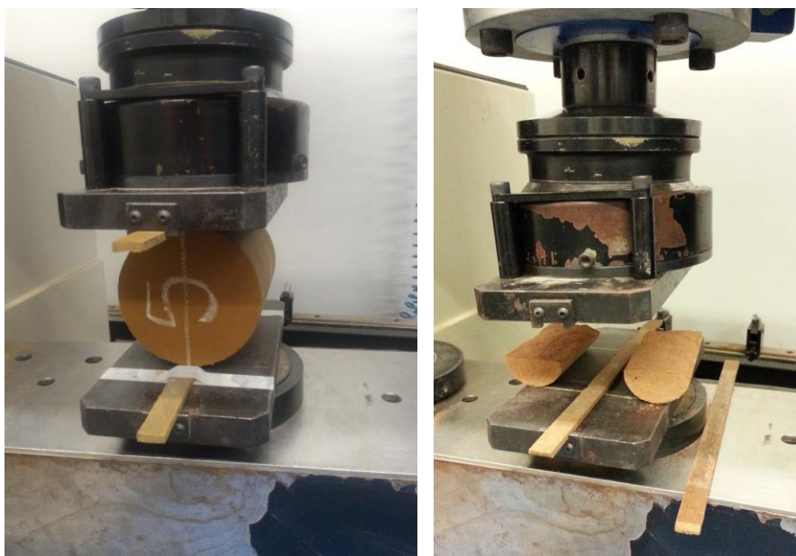
Figura 4.18 - Corpo de prova em ensaio e rompido, na 1ª determinação da resistência à tração por compressão diametral do solo cimento
