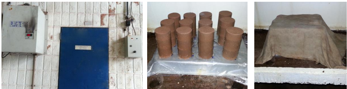
Figura 3.14 - Aspecto externo da câmara úmida (com controles automáticos de temperatura e umidade) e corpos de prova durante a cura em seu interior
