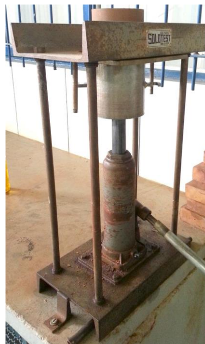
Figura 3.11 - Extrator hidráulico manual, para o CP 10x12,7 adotado pela norma NBR 7182 (ABNT, 1986)
