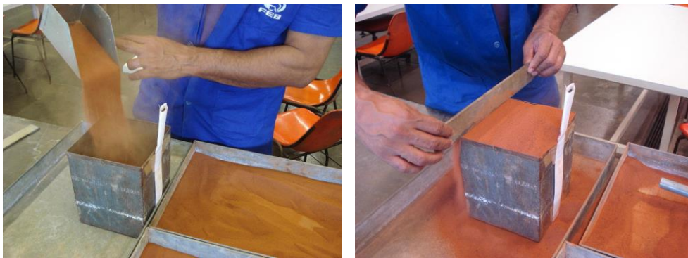
Figura 3.04 - Ensaio de determinação da massa unitária do solo solto e seco ao ar
