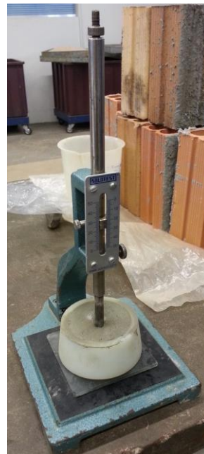
Figura 3.02 - Aparelho de Vicat, com a sonda em penetração, para determinação da pasta de consistência normal
