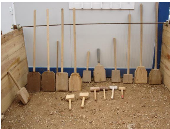
Figura 2.21 – Variedade de compactadores manuais tradicionais, utilizados na consolidação das ruínas do Castelo de Paderne (sec. XII) com paredes de taipa militar (2,10 m de espessura), em Albufeira - Portugal (fotos de Obede B. Faria, 2005)
