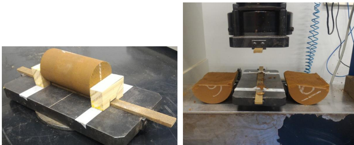
Figura 3.18 - Posicionamento de um CP 5x10, com auxílio do gabarito de madeira (esquerda) e ensaio de um CP 10x12,6, notando-se a ruptura no plano diametral (direita)
