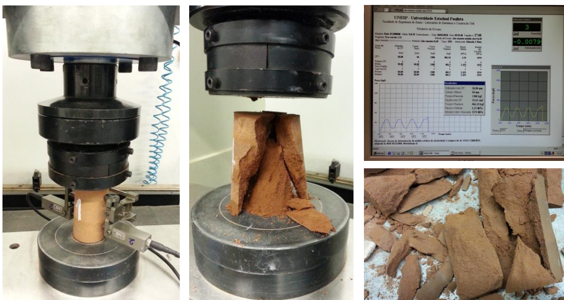
Figura 4.15 - Aspectos do ensaio de determinação do módulo estático de elasticidade na compressão do solo cimento, notando-se: instalação dos extensômetros, padrão de ruptura dos corpos de prova e tela de interface do software de comando da máquina de ensaios
