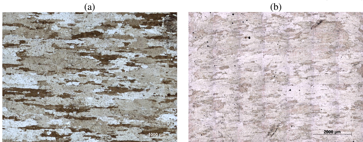
Figura 41 – Detalhe central da macroscopia das amostras atacada com reagente Keller: (a) #1 (0%); (b) #2 (26%); (c) #3 (39%); (d) #4 (43%); (e) #5 (50%); (f) #6 (57%); (g) #7 (59%); (h) #8 (64%).
