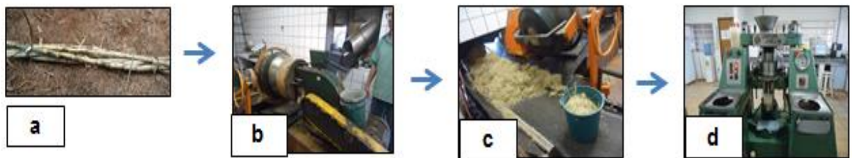
Figura 8. Amostra de colmos para extração do caldo e bagaço (a); desintegração do colmo (b); amostragem do material desintegrado (c); prensa hidráulica para extração do caldo e bagaço (d). Catanduva-SP, 2014.
