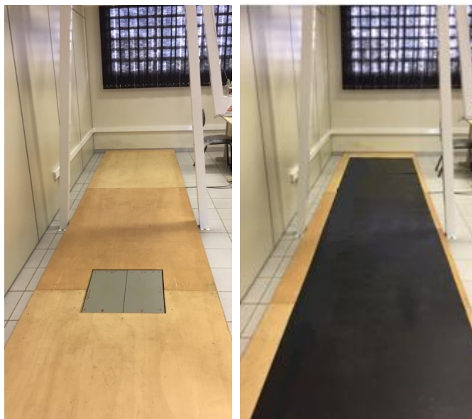
Figura 1. Passarela com plataforma de força utilizada para coleta de dados.
