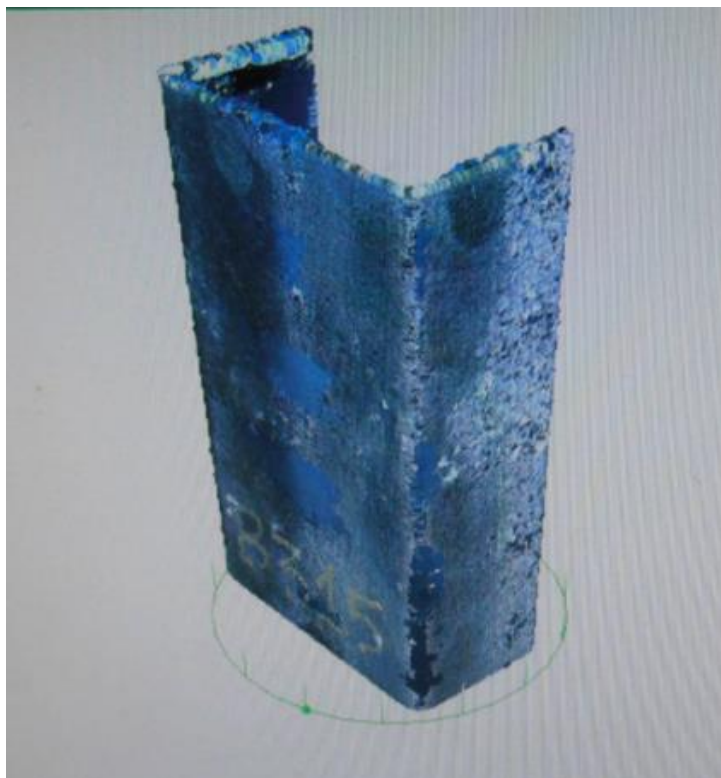
Figura 4.6 – Captura tridimensional da nuvem de pontos para gerar o corpo de prova por escaneamento
