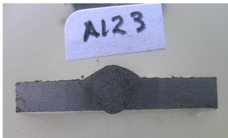
Figura 8.39 – Análise macrográfica do corpo de prova A123
