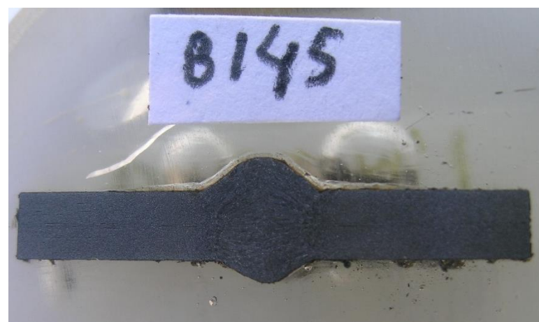
Figura 8.49 – Análise macrográfica do corpo de prova B145
