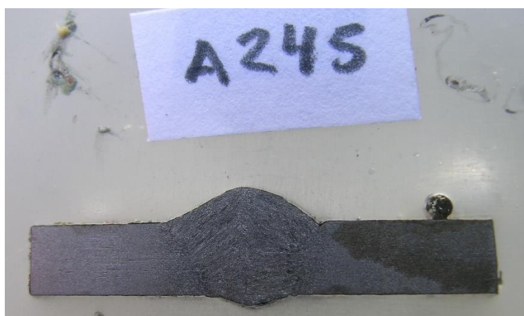
Figura 8.45 – Análise macrográfica do corpo de prova A245
