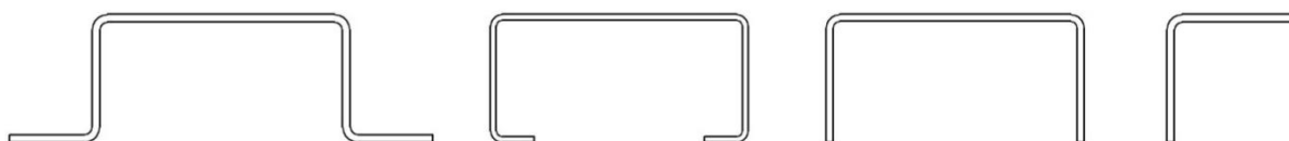
Figura 3.3 – Perfis dobrados a frio tipo “Ômega, C, U e L”
