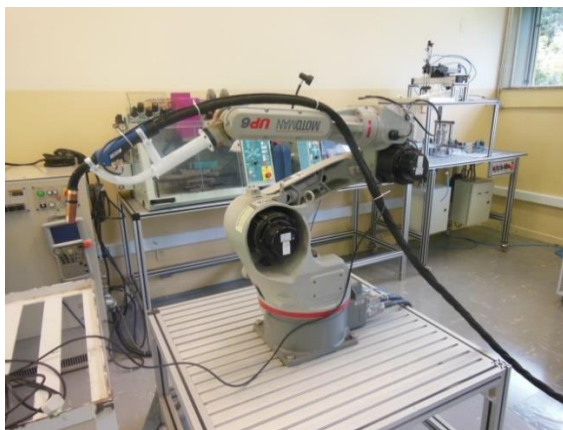
Figura 4.1 - Acoplamento do braço robótico e tocha de soldagem
