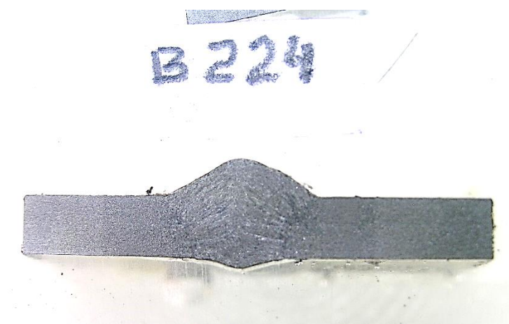
Figura 5.15 – Análise macrográfica do corpo de prova B224
