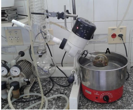
Figura 8. Extrato obtido sendo evaporado no rotoevaporador. A: Balão contendo os extratos obtidos em triplicata no aparelho Soxlet.
