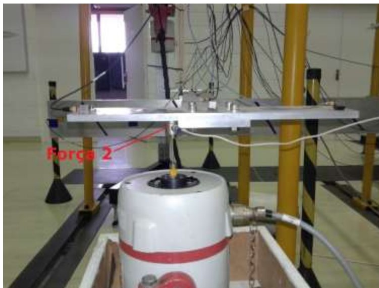
Figura 17 – Fixação do transdutor de força (Força 2)
