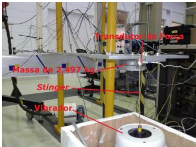
Figura 25 – Foto do experimento 2: estrutura modificada
