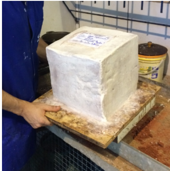
Figura 27 - Amostra indeformada parafinada e etiquetada.
