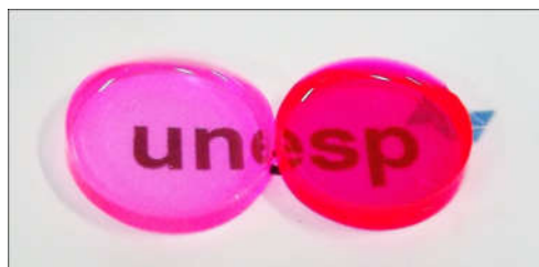
Figura 4.3 – Fotografia de dois xerogéis com diferentes concentrações de Rodamina-B. Apresentam elevada qualidade óptica, sem qualquer tipo de trinca.
