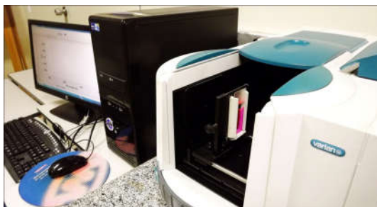
Figura 5.4 – Fotografia do espectrofotômetro de absorção UV/VIS Varian Cary 50® utilizado com computador para aquisição de dados ao fundo.
