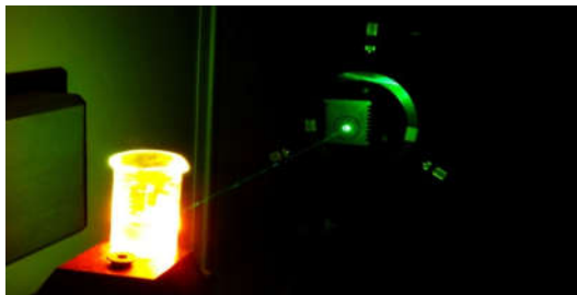
Figura 1.2 – Fotografia de uma amostra de sol à base de GPTS-TEOS dopado com Rodamina-B durante excitação por laser verde de \lambda = 532 nm.
