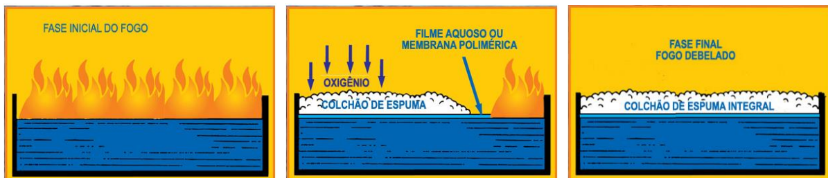
Figura 1: Esquema de Funcionamento da espuma (AFFF) na extinção de incêndio. Fonte: Técnica Segurança em Risco
