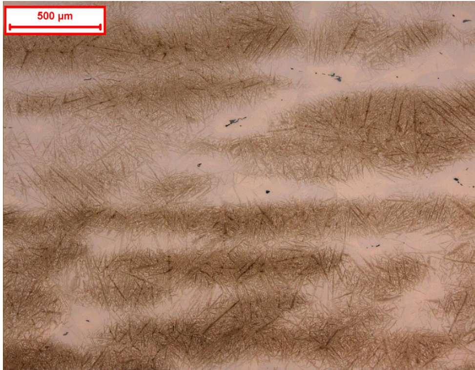
Figura 60 – Amostra com 0,6 de deformação com 8h de homogeneização (Amostra 22D-8h).
