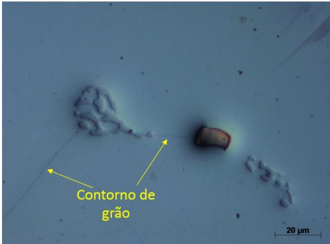
Figura 53 – Precipitados formados na região de contorno de grão durante a solidificação (Amostra ND-0h). Imagem obtida utilizando contraste por interferência circular (C-DIC).
