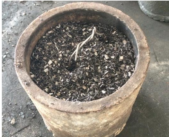
Figura 42 – Amostras amarradas e envoltas em cavaco de ferro fundido cinzento.
