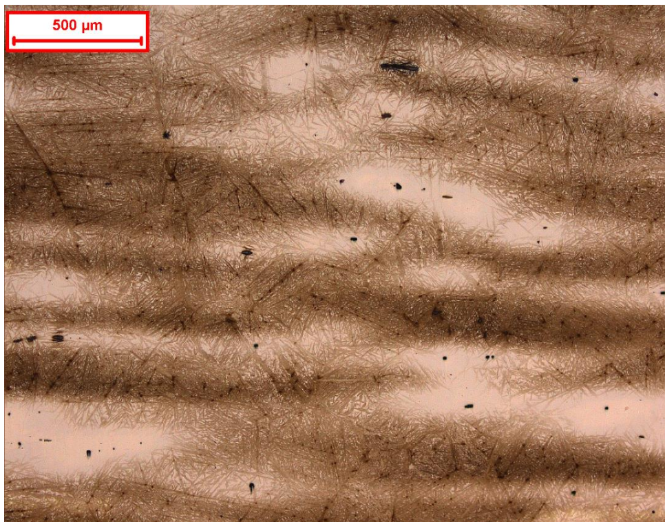
Figura 63 – Amostra com 1,3 de deformação com 8h de homogeneização (Amostra 11D-8h).
