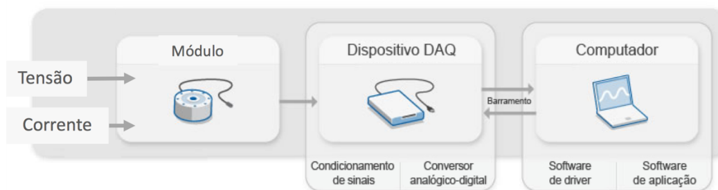
Figura 28 – Esquema do procedimento utilizado para a medição da potência
