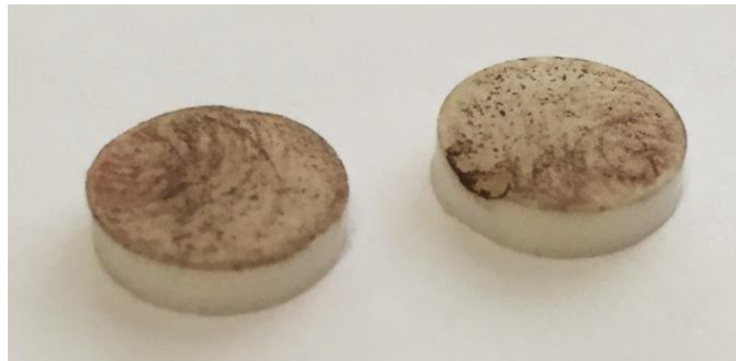
Figura 2 - Corpos de prova em zircônia revestidos com \alpha -Ag 2 WO 4
