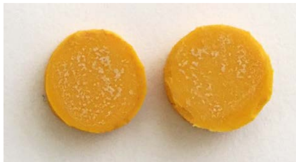
Figura 3 - Corpos de prova em silicone de adição revestidos com \alpha -Ag 2 WO 4
