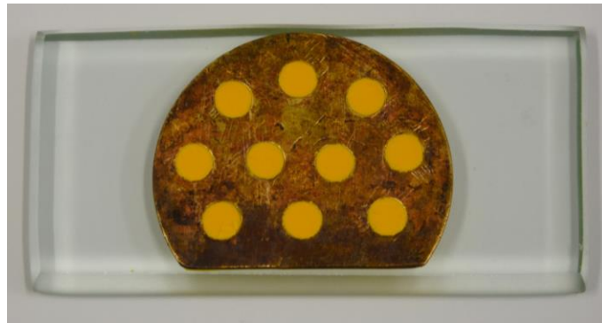
Figura 1 - Silicone de adição inserido na matriz metálica, após a prensagem e polimerização.
