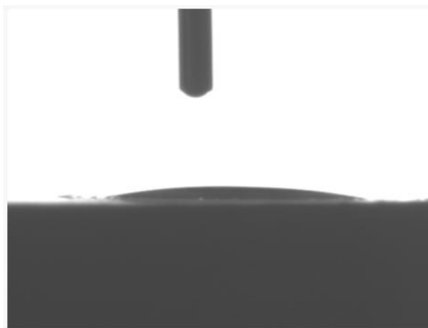
Figura 15 - Imagem da gota de água sobre espécime de Ti-30Ta: (Grupo II - Tratado)
