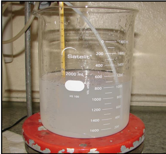
Figura 10 - Preparo do SBF com inserção de \text{CO}_2 (A) início e (B) final do preparo
