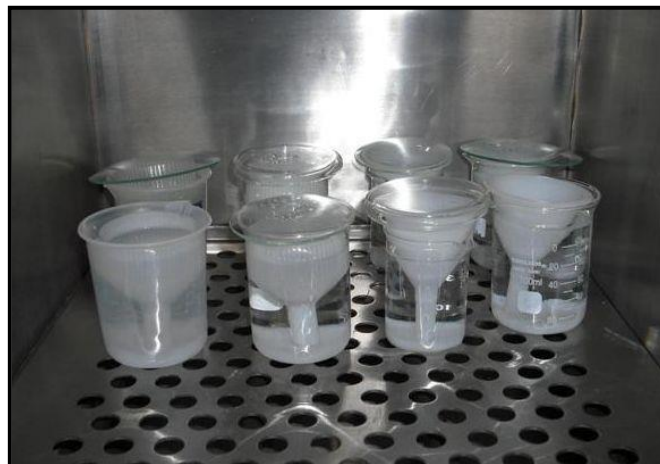
Figura 11- Detalhe das amostras imersas em SBF utilizando funil para homogeneização do depósito da apatita
