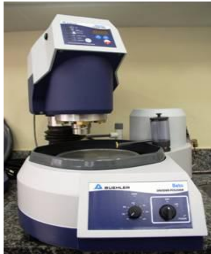
Figura 2 - Politriz utilizada para a planificação da dentina e polimento do esmalte.
