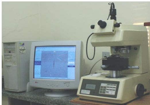
Figura 4 - Microdurômetro acoplado ao Software para análise de imagem.
