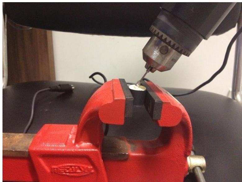
FIGURA 6. Vista aproximada da chave hexagonal posicionada sobre o corpo-de-prova devidamente estabilizado pelo dispositivo.
