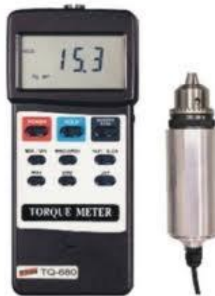
FIGURA 5. Medidor digital de torque (Instrutherm TQ-680) - Equipamento obtido com Auxílio à Pesquisa FAPESP – 2009/15060-3.
