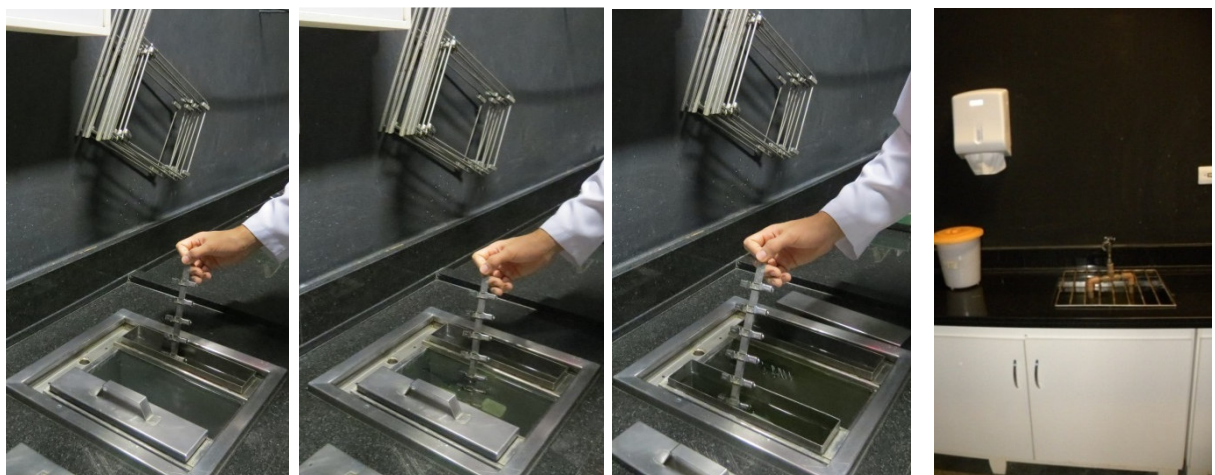
Fig.23- Processamento radiográfico: revelador, lavagem intermediária em água, fixador, lavagem final em água corrente.
