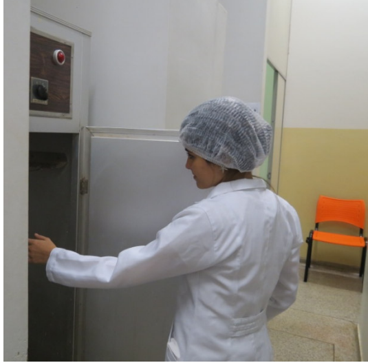
Fig.24- Secagem dos filmes radiográficos em secadora.
