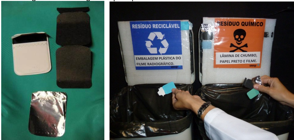
Fig.22- Embalagem do filme radiográfico contendo invólucro plástico, papel preto e lâmina de chumbo. Descarte dos resíduos reciclável e químico.
