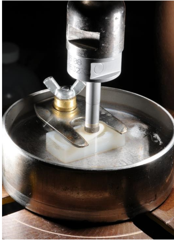
Figura 2 – Dente bovino posicionado em furadeira de bancada para obtenção das unidades experimentais.
