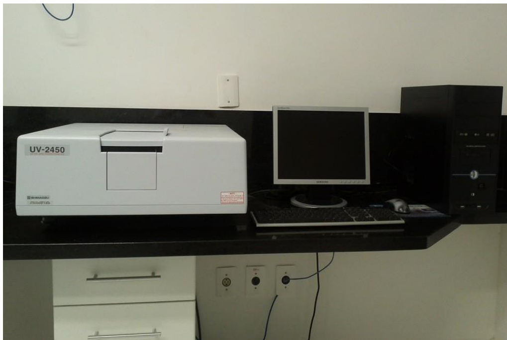
Figura 6 - Espectrofotômetro de Reflexão Ultravioleta Visível* Modelo UV-2450 (Shimadzu, Kyoto, Japão).
