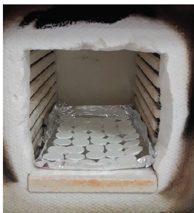
Figura 7 - Secagem das amostras dentro do forno de cera após lavagem cuidadosa com água destilada
