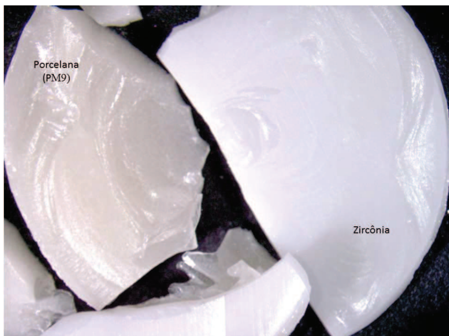
Figura 22 – Falha de uma amostra com zircônia na face de tração
