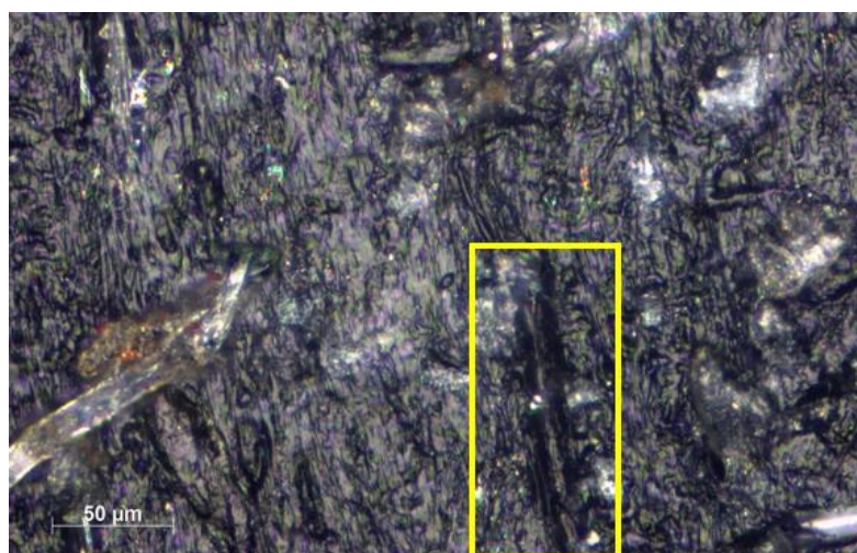
Figura 63- Imagem topográfica do arrancamaneto de fibras de vidro da madeira plástica
