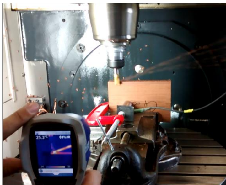
Figura 40- Corpo de prova de WPC sendo usinado pelo processo de fresamento tangencial
