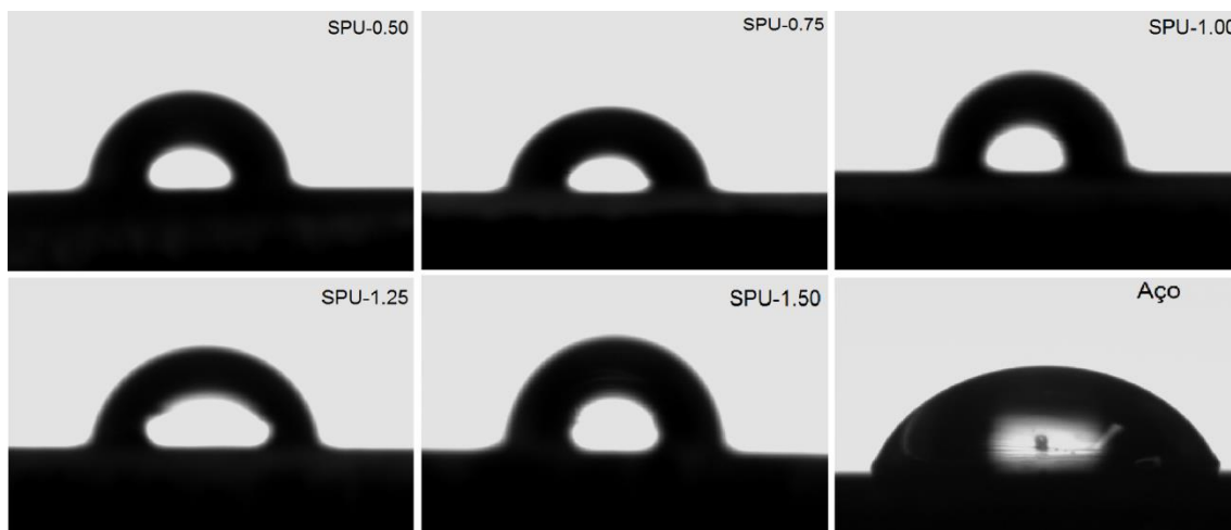
Figura 35- Espalhamento da gota de água na superfície do aço com e sem revestimento com os filmes híbridos.
