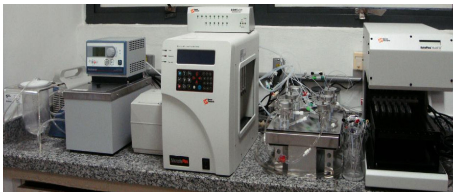
Figura 5: Equipamento automatizado de permeação cutânea (Hanson Corporation) e Célula de Difusão de Franz.
