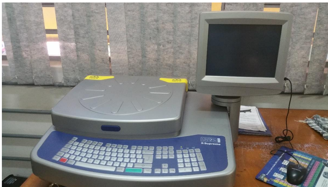
Figura 3 – Espectrômetro de Raios X
