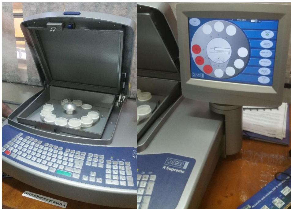
Figura 24 – Introdução das amostras no Espectrômetro de Raios X
