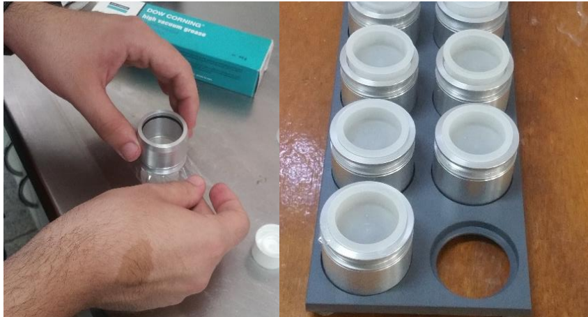
Figura 23 – Preparação das amostras – Espectrômetro de raios X
