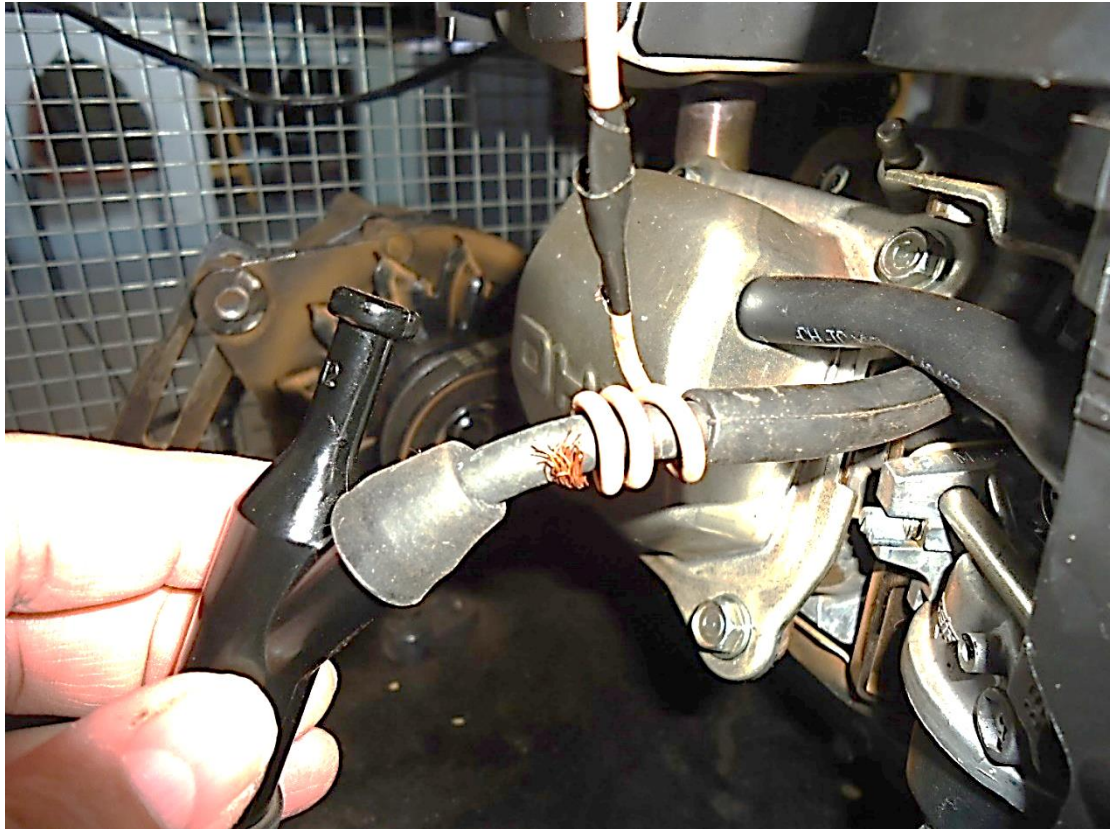
Figura 10 – Montagem do fio do horímetro no cabo de vela
