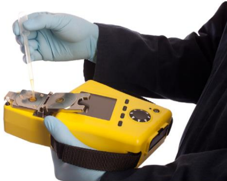
Figura 33 – Carregamento do óleo no Fluid Scan Q1000
