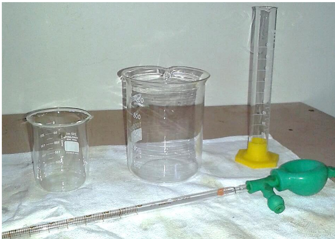
Figura 11 – Equipamentos utilizados para manipular o combustível
