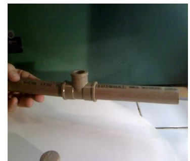
Figura 61. Peça de acoplagem T. Figura 62. Encaixe dos canos PVC. Figura 63. Montagem concluída.
